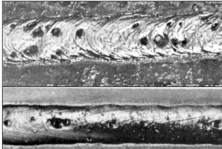
Figura 35 - Solda com inclusão de escória
