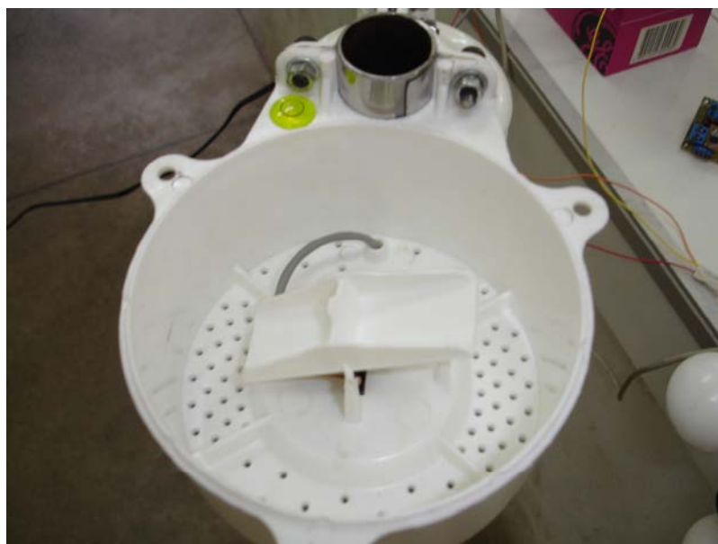
Figura 13 - Sensor de precipitação pluvial com o reservatório basculante.
