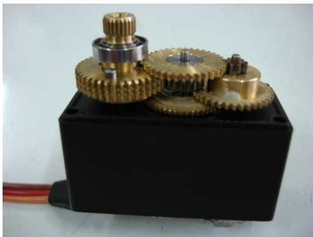
Figura 17 - Micro servo-motor com detalhes das engrenagens.
