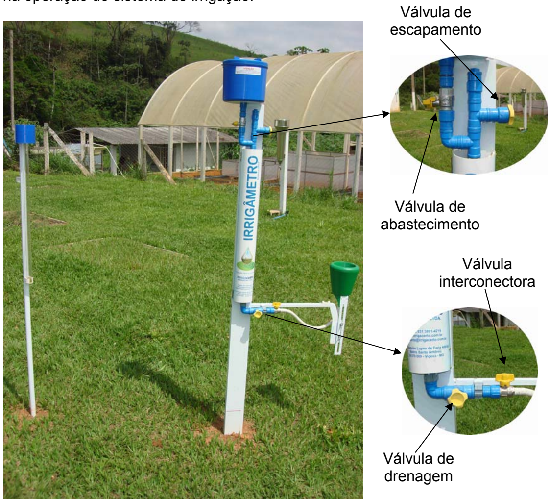
Figura 2 - Aparelho instalado na Unidade de Pesquisa e Desenvolvimento do Irrigâmetro, localizada em Viçosa, MG. À esquerda observa-se o coletor pluvial. Em detalhes, as válvulas de abastecimento, escapamento, drenagem e interconectora.
