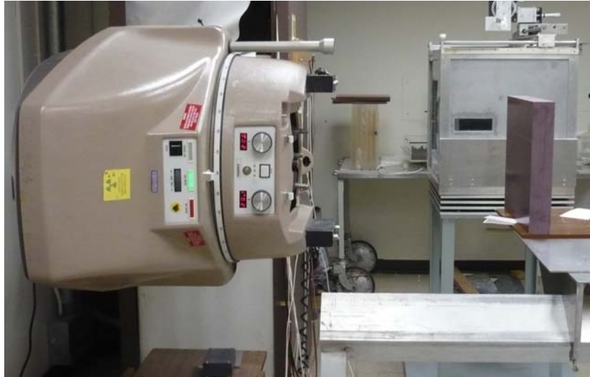
Figura 5.2 – Configuração experimental para irradiação dos tubos de gel com feixe de Cobalto-60.
