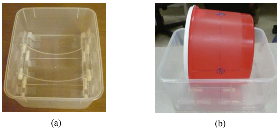
Figura 6.1 – (a) Suporte usado para posicionamento do gel (b) ilustração do posicionamento do gel para a aquisição do CT e do tratamento.
