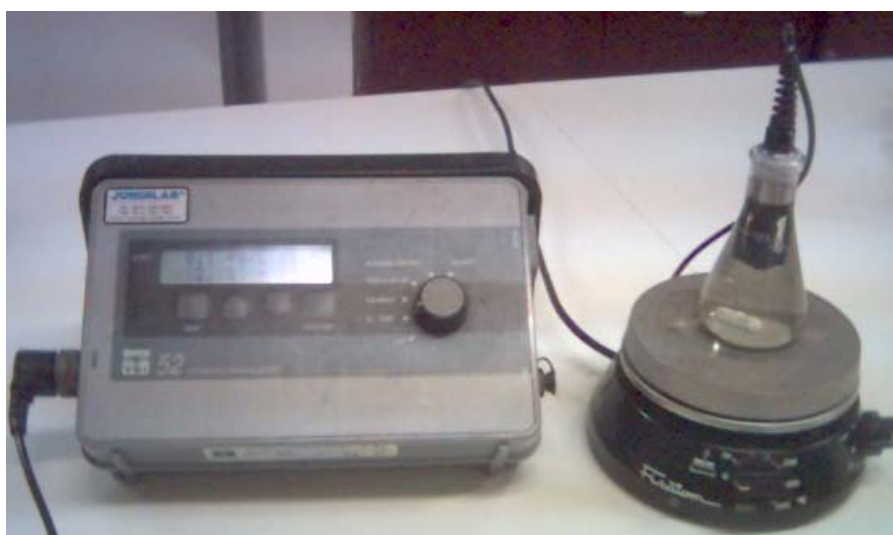
Figura 3.3 – Medida da concentração de oxigênio com o oxímetro YSI, modelo 52CE na amostra do gel MAGIC com formaldeído.
