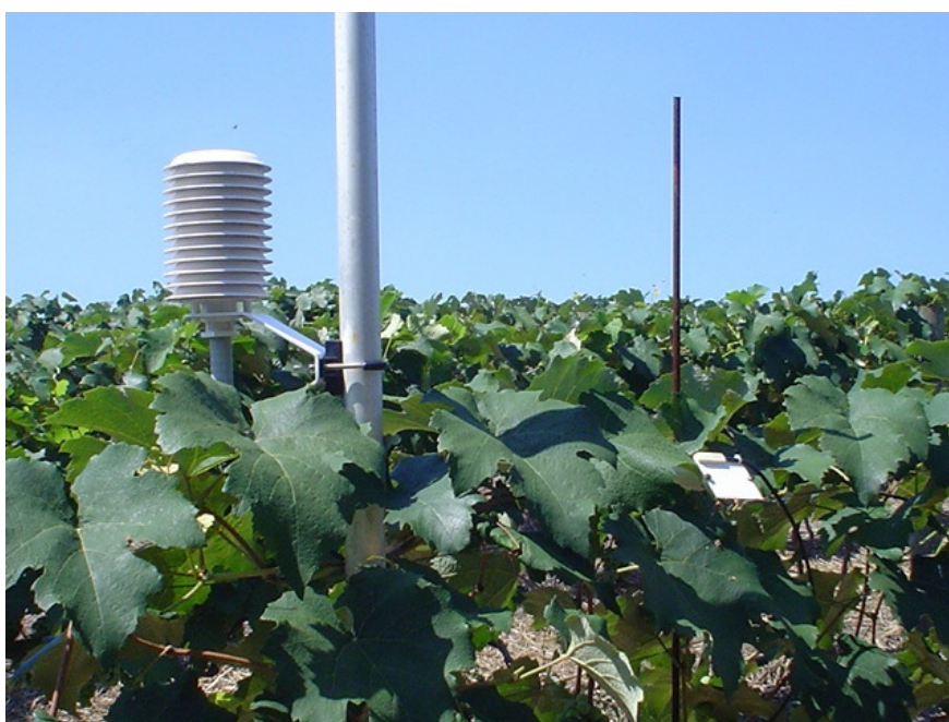
Figura 4 – Localização do abrigo meteorológico e sensor de DPM no vinhedo.
