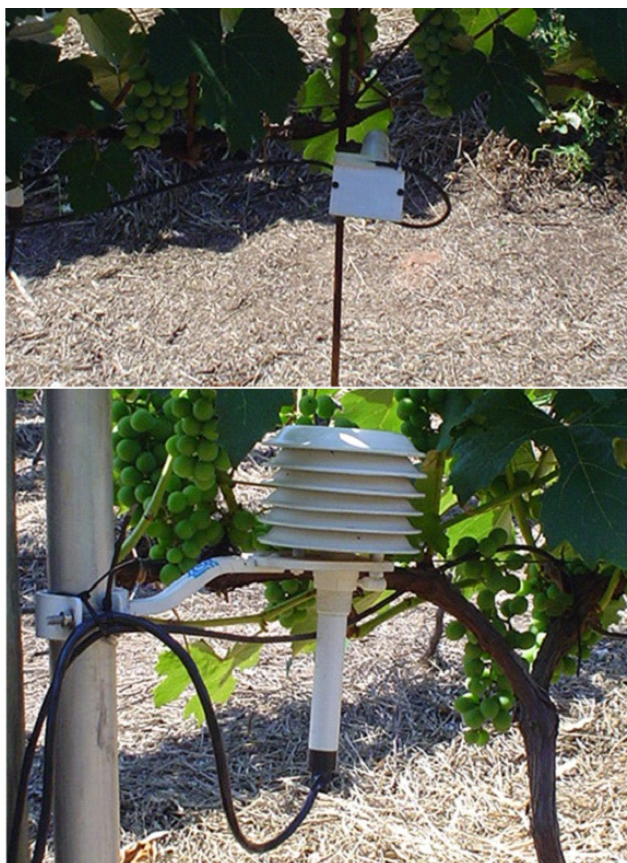
Figura 5 – Localização do abrigo meteorológico e o sensor de DPM na altura dos cachos.
