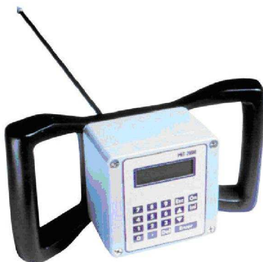
Figura 2 - Vista frontal do penetrômetro utilizado.
