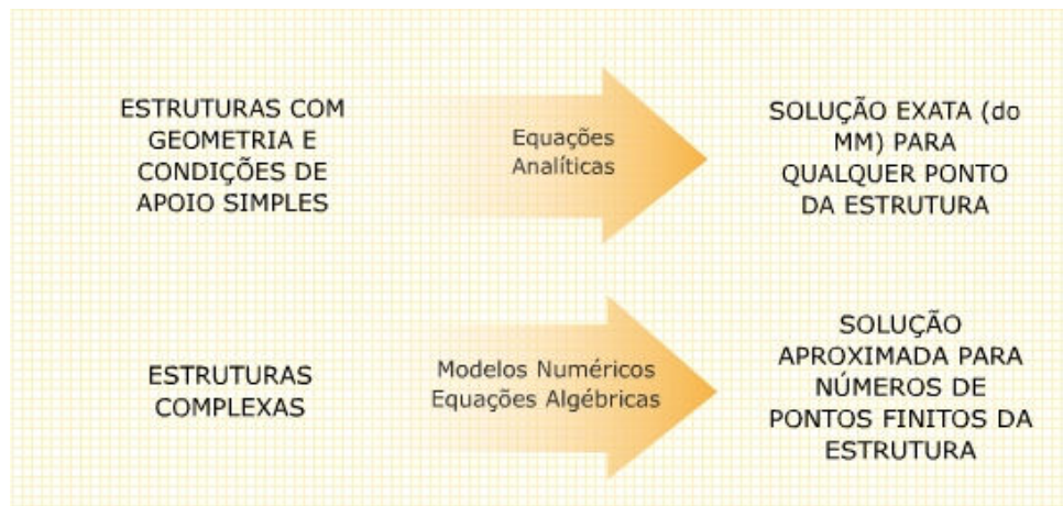
FIGURA 01 – Tipos de Estruturas e soluções
