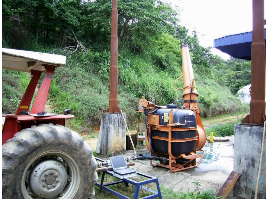
Figura 8 – Vista geral da bancada de aquisição de dados e pulverizador.
