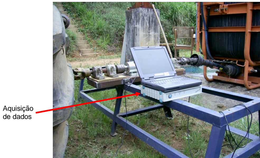
Figura 6 – Equipamentos de aquisição dos dados de torque e rotação.
