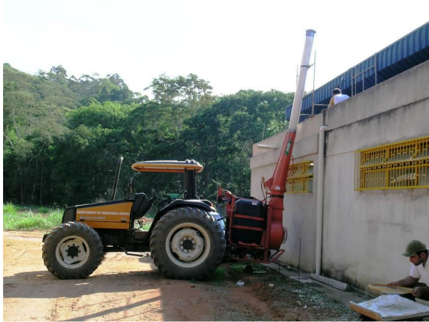
Figura 3 – Pulverizador e tubo homogeneizador.
