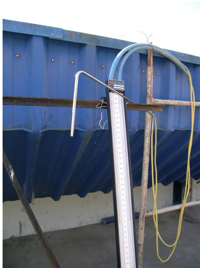
Figura 4 – Tubo de Pitot e coluna d'água graduada.
