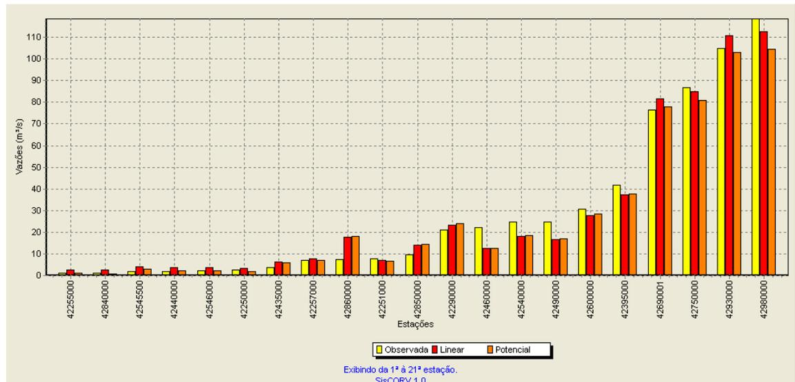
Figura 57 –  $Q_{\text{mma}}$  observadas e estimadas pelos modelos linear e potencial do método da curva adimensional.
