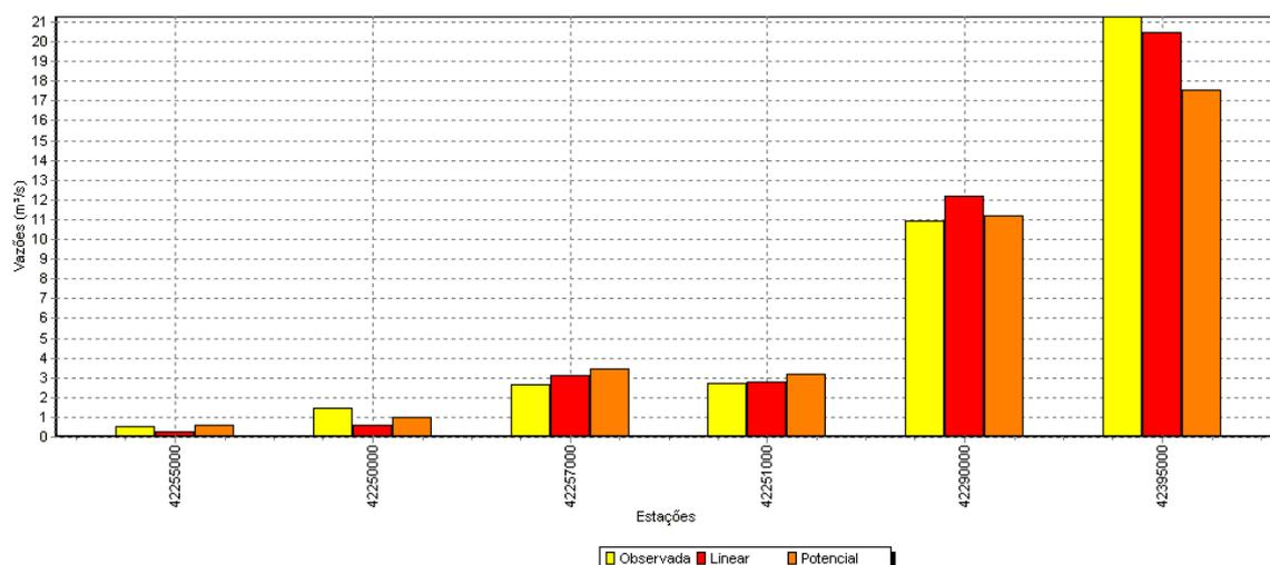
Figura 54 – Q<sub>7,10</sub> observadas e as estimadas pelo método tradicional para cada uma das estações fluviométricas usadas no estudo de caso.
