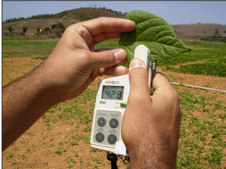
Figura 4. Medidor portátil de clorofila SPAD 502.
