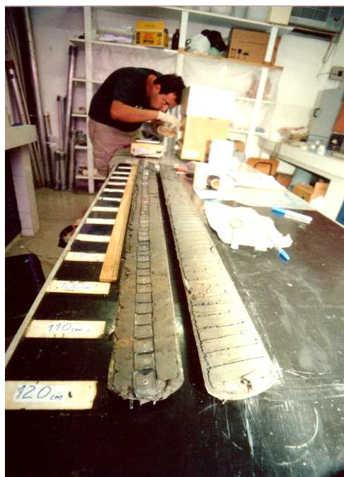
Figura 13 Amostragem das fatias do testemunho para a densidade aparente.
