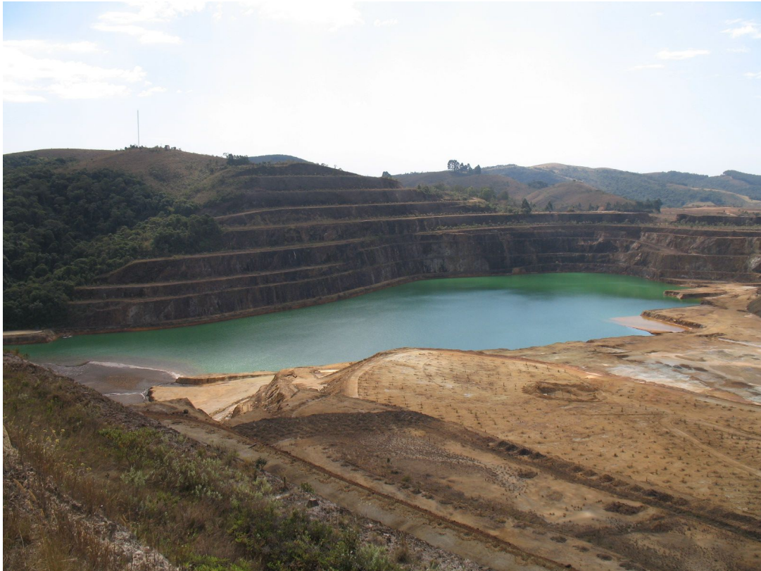
Figura 17: Lago da cava com drenagem ácida.
