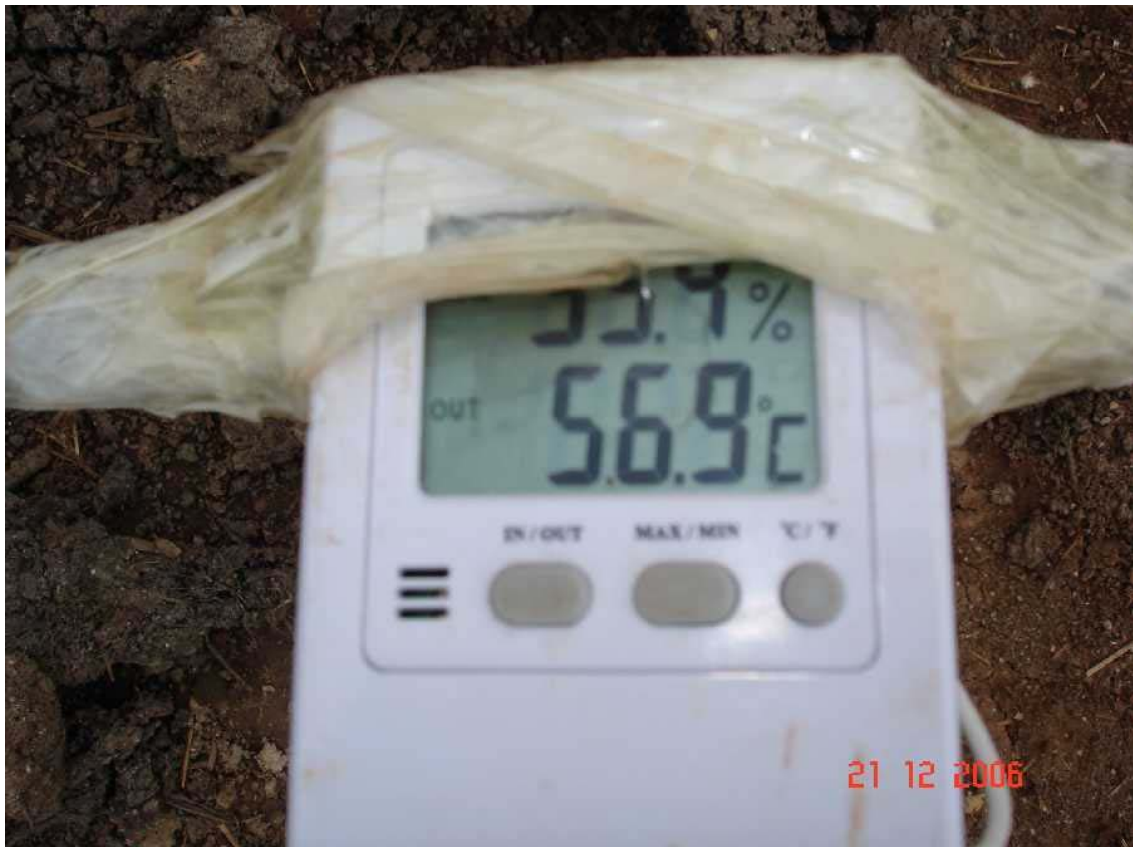
Figura 27 – Temperatura medida em pilha revolvida de esterco de ave poedeira, com a utilização de termômetro digital.
