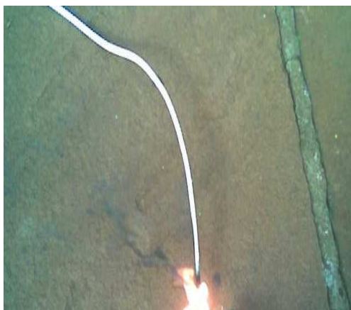
Figura 43 - Início do fogo introduzido no conjunto espoletado.
