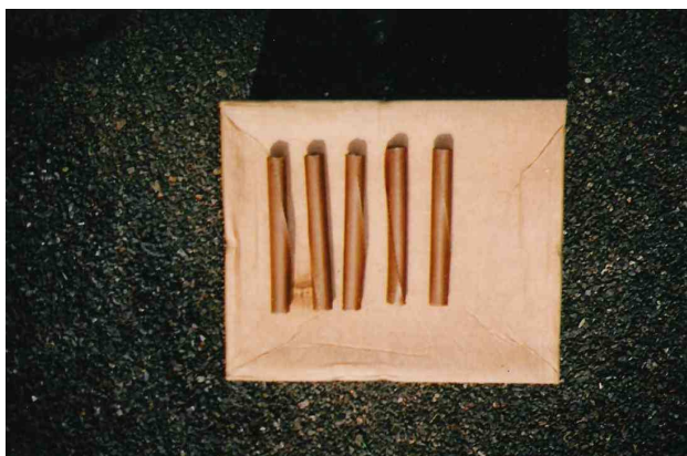
Figura 33 - “Bananas de 1/8” empregadas em pedreiras/ valas.
