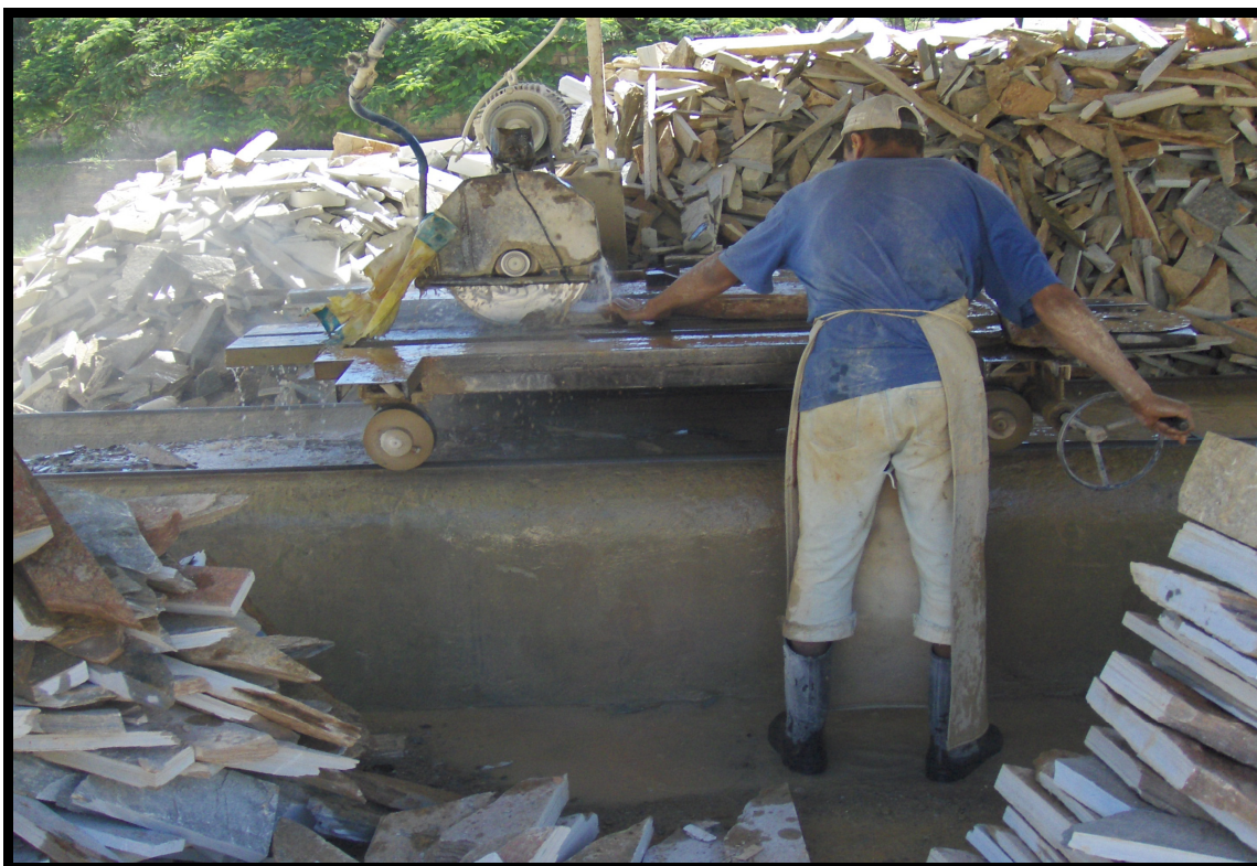
FIGURA 4.11 – Rejeitos gerados pelo processo de corte dos blocos (Janeiro de 2008)
