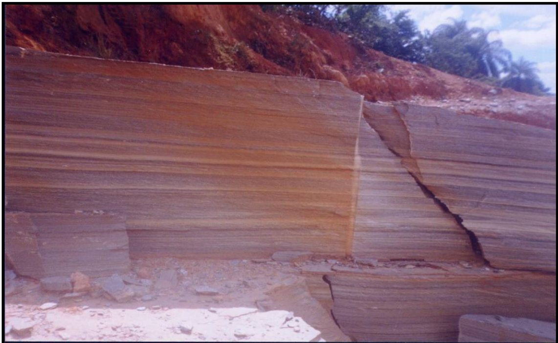
FIGURA 2.2 – Vista Frontal “in situ” de um bloco de calcário dolomítico da pedra Lagoa Santa
