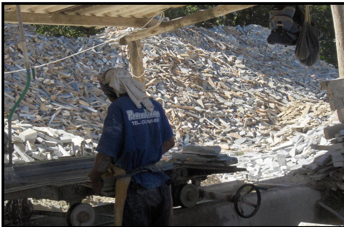
FIGURA 4.13 – Unidade de beneficiamento do APL Lagoa Santa, mostrando a deposição inadequada de rejeitos (Novembro de 2007)
