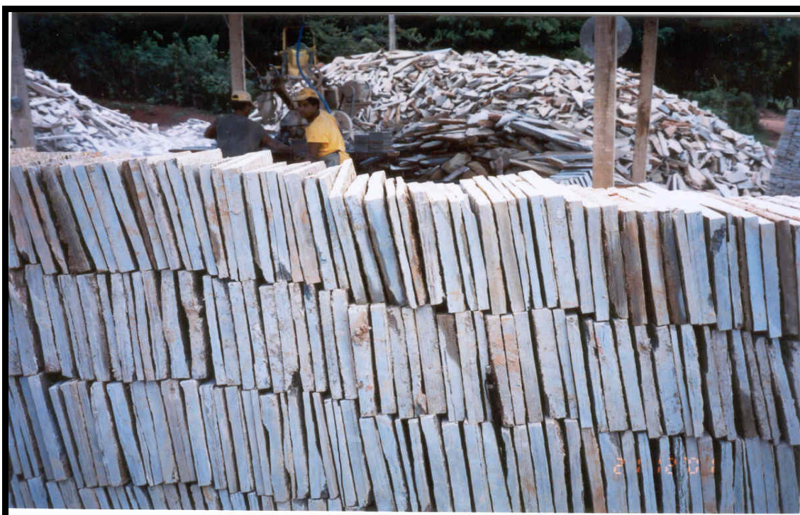
FIGURA 4.17 – Faixa de variação de espessura do produto acabado (Janeiro de 2008)
