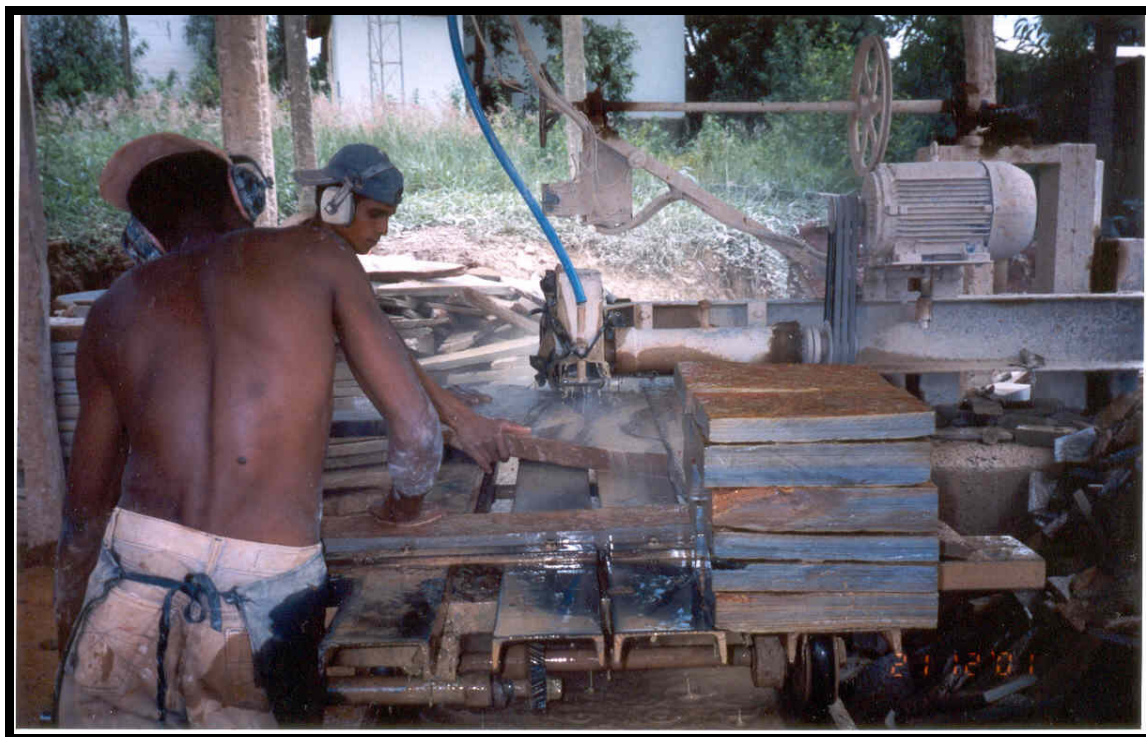
FIGURA 4.10 – Placa da pedra Lagoa Santa sendo serrada em blocos menores (Março de 2007)
