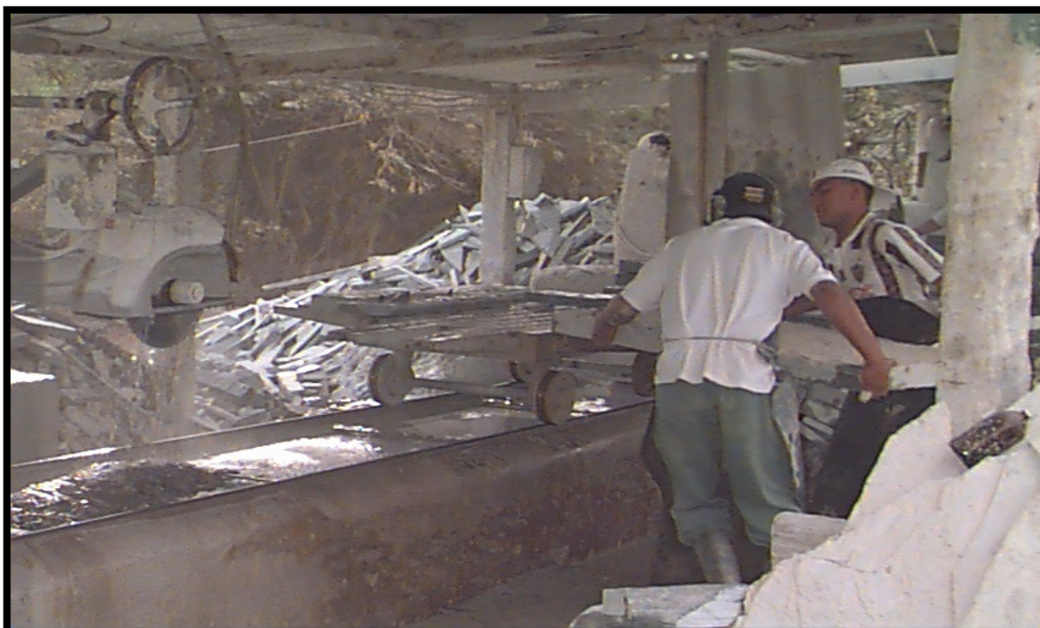
FIGURA 4.8 – Unidade de beneficiamento em operação no APL Lagoa Santa, mostrando o uso da serra de corte circular (Março de 2007)
