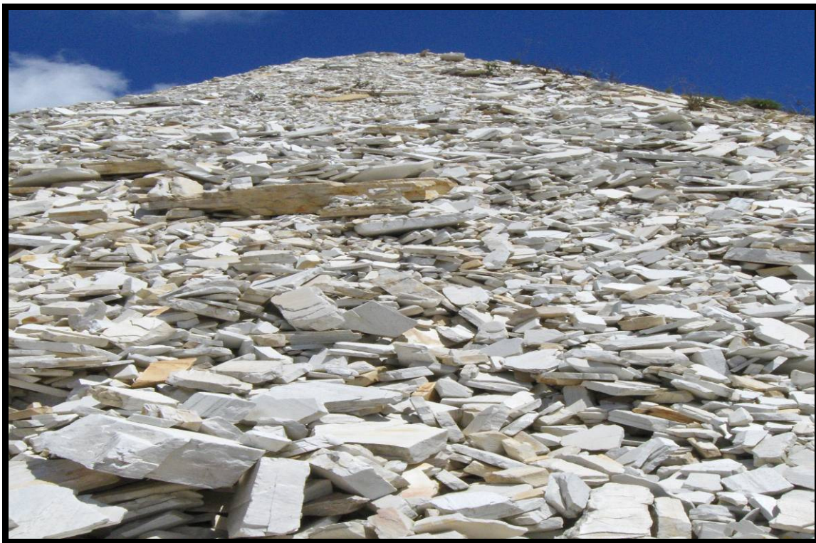
FIGURA 2.11 – Pilha de entulho abandonada na pedreira da pedra São Tomé com uma altura de aproximadamente 20 metros (Novembro de 2007)
