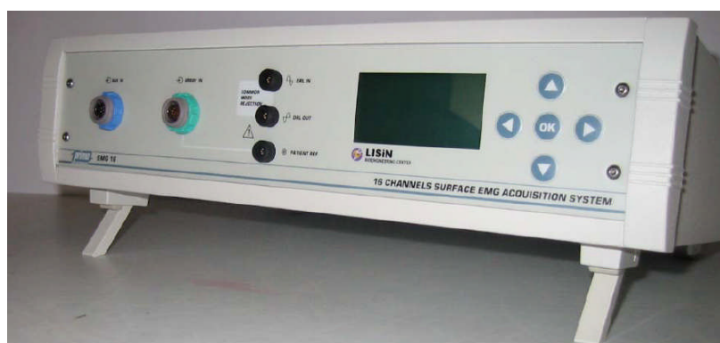
Figura 10 – Eletromiógrafo EMG-16 (LISiN – Ot Bioelettronica – Torino, Itália).
