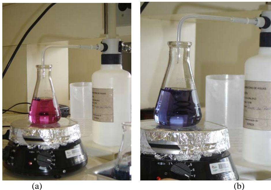
Figura 10: Titulação das amostras para o ensaio de dureza e ponto de viragem da solução.
