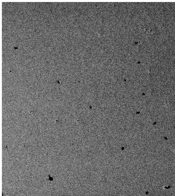
Figura 7 - Metalografia da amostra usinada, exibindo poros isolados, implante rugoso.
