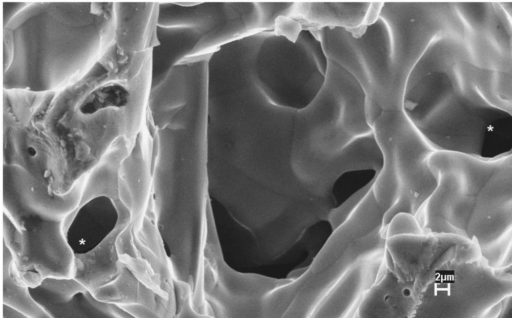
Figura 6 - Fotomicrografia de MEV com aumento de 1500x: observar a interligação entre os poros (\*), implante poroso.
