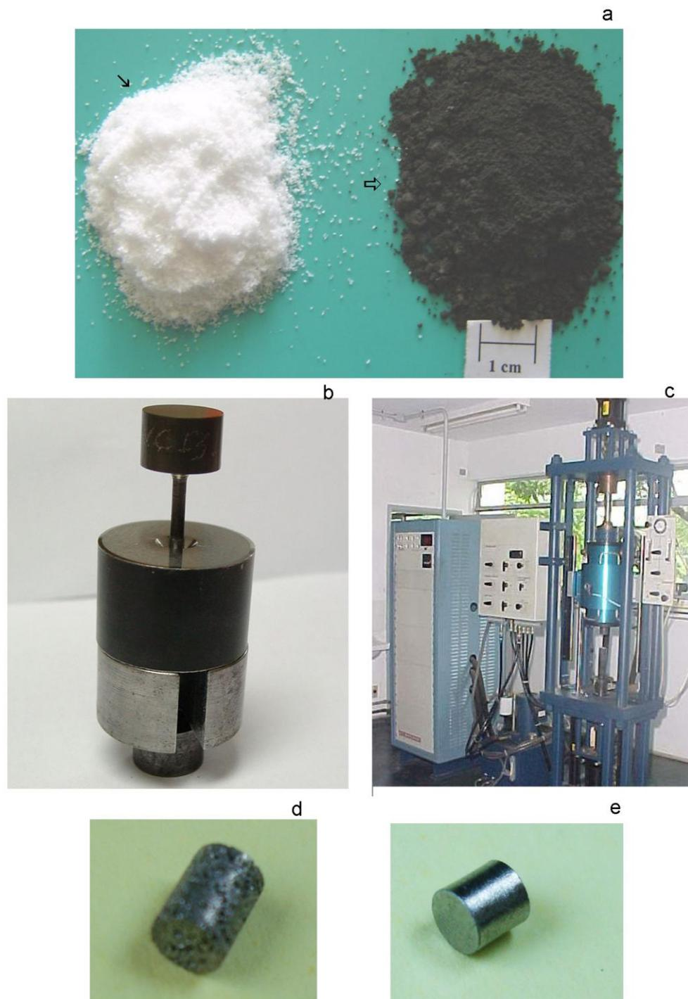
Figura 1 - Procedimentos da confecção dos implantes: a) pó de uréia (↘), pó de titânio (⇒); b) matriz utilizada para a compactação uniaxial; c) forno a vácuo utilizado para a sinterização; d) visão aproximada do implante poroso, e) visão aproximada do implante rugoso.
