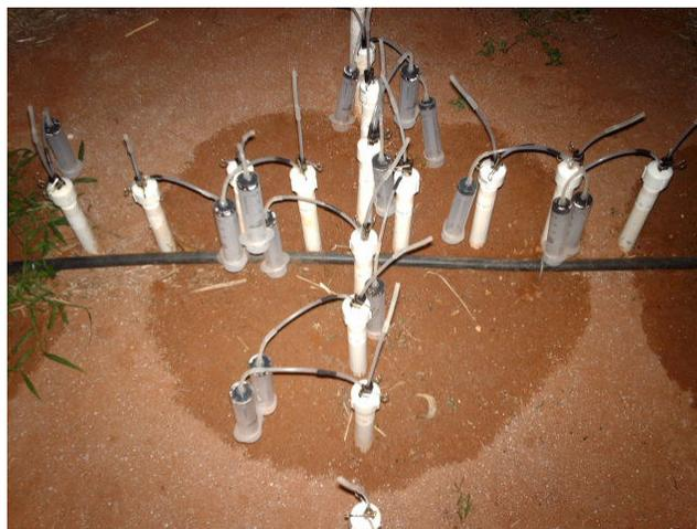
**FIGURA 2.** Extratores de solução no ensaio.
