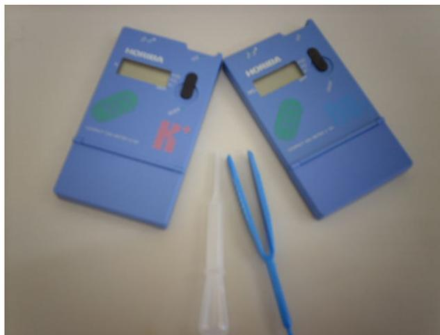
**FIGURA 4.** Medidores de íons específicos  $\text{K}^+$  e  $\text{NO}_3^-$  da marca Horiba (Cardy).
