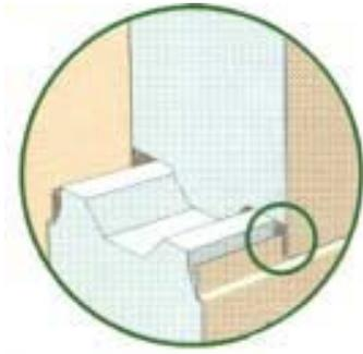
Figura 3.4 – Detalhe interno de encaixe (Isoeste, 1999)
