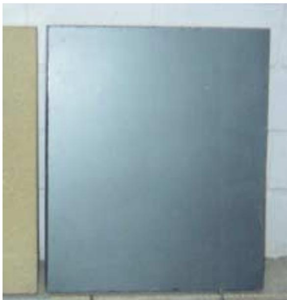
Figura 7.22 – Acabamento após a cura do concreto utilizando pintura automotiva (poliuretânica) junto ao painel da Precon
