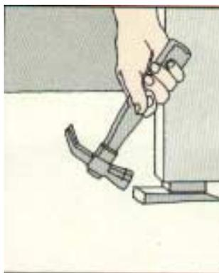
Figura 5.11 – Cunhamento dos painéis (Siporex, 1999)
