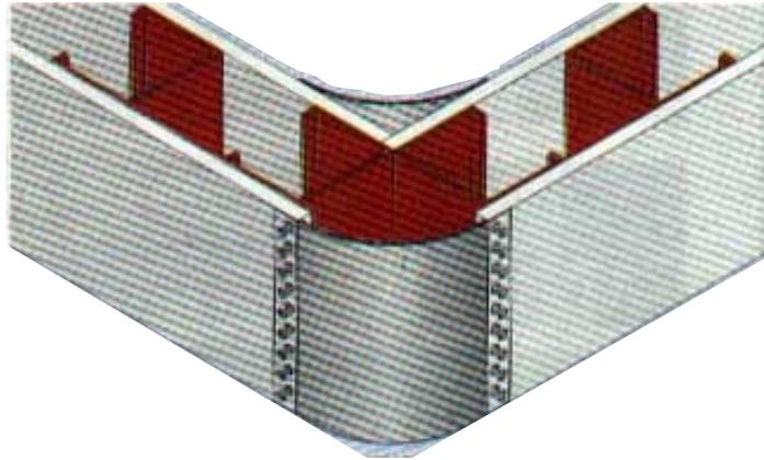
Figura 4.30 – Reforço de canto utilizando perfis metálicos curvos (Mitidieri Filho, 1997)
