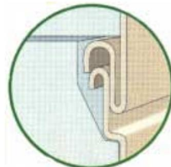
Figura 3.5 – Detalhe de encaixe macho-fêmea (Isoeste, 1999)
