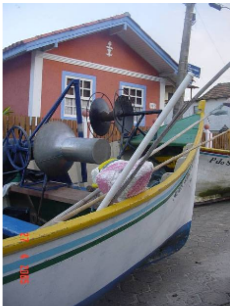
Figura 17 – Embarcação equipada com rolo, guincho, bandeiras de taquara e roncador.
