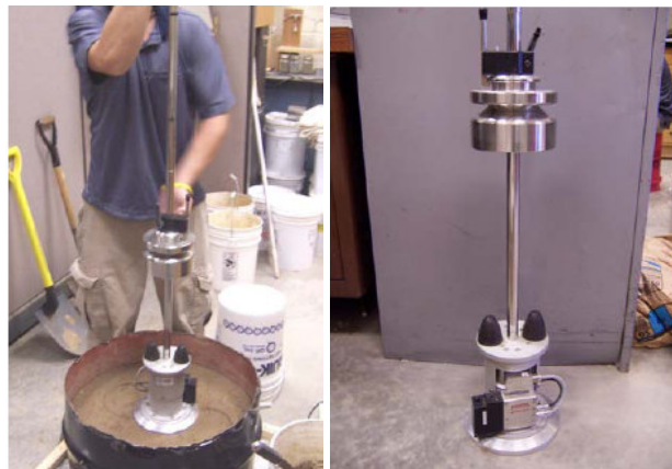
Figura 29 – Ensaio LWD e equipamento LWD
