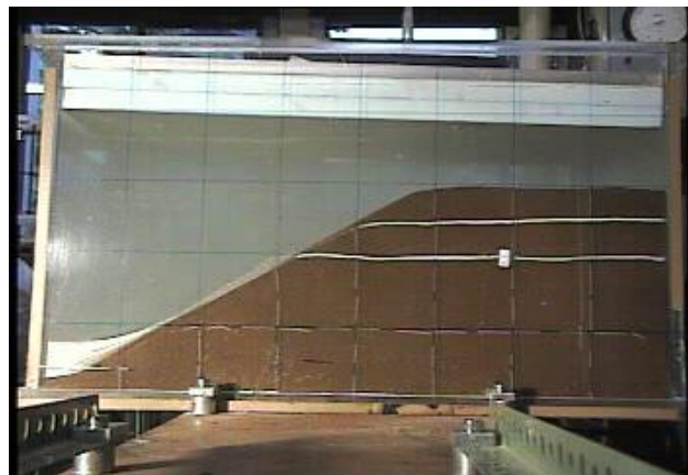
Figura 2.17 – Modelo hidráulico estudado por Kokusho (1999)
