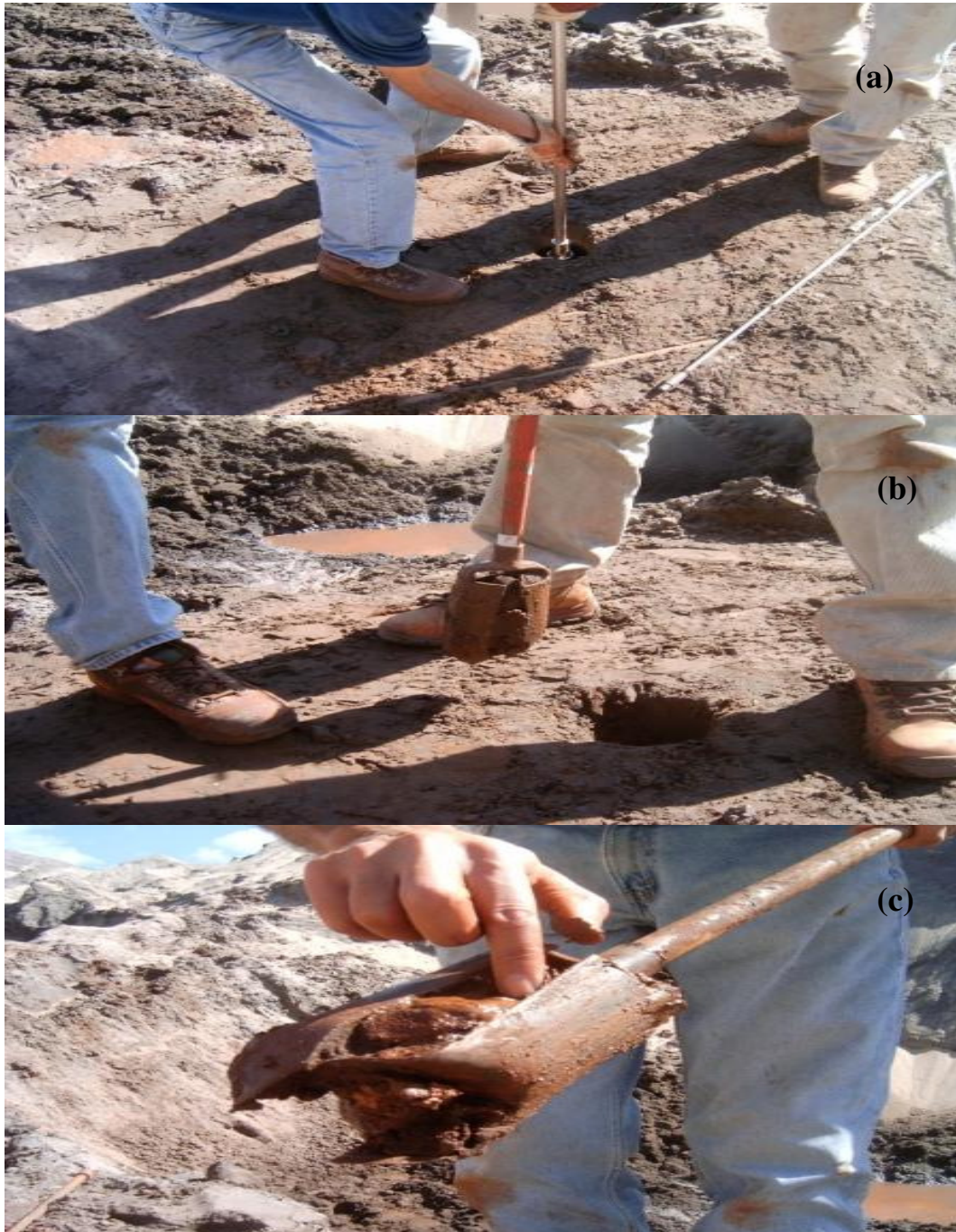
Figura 4.48 – Etapas da amostragem 3 – (a) Coleta de amostras com auxílio de amostrador do tipo pistão; (b) Recuperação de amostras com trado manual; e (c) Identificação tátil-visual da amostra colhida
