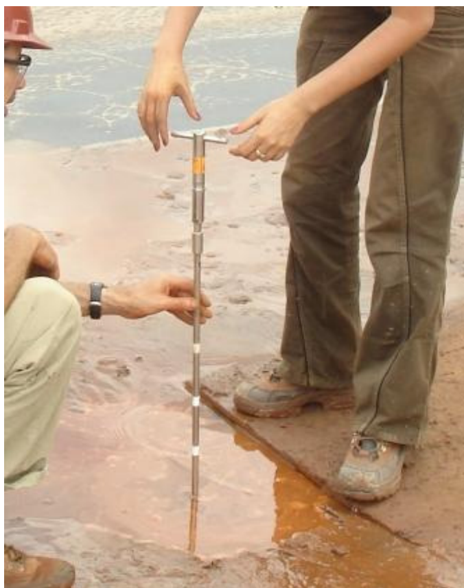
Figura 3.5 – Execução do ensaio de palheta
