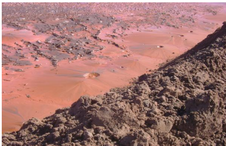
Figura 2.21 – Surgimento de Sand Boils em um depósito de rejeitos de minério de ferro
