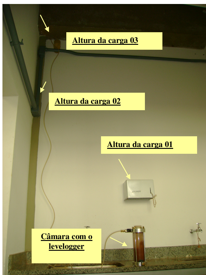
Figura 3.10 – Arranjo utilizado para teste nos 3 tipos de solo, identificando as alturas de carga utilizadas
