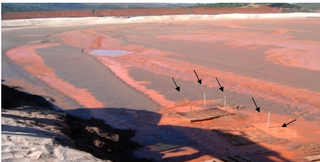
Figura 3.12 – Posicionamento dos leveloggers antes do carregamento
