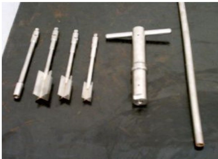
Figura 3.4 – Detalhe do aparelho palheta utilizado (Penna, 2006)
