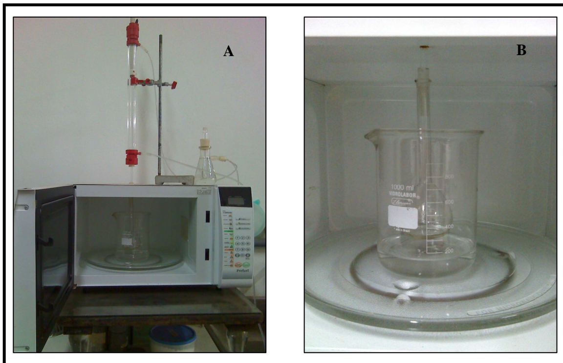
Figura 08: Microondas adaptado para a fragmentação do BBIM com ácido fórmico. A - Ilustração do condensador incorporado no equipamento microondas. B - Ilustração interna do microondas. O balão volumétrico contendo a solução a ser fragmentada é preso no silicone de modo a evitar perda de amostra. Bêquer contendo aproximadamente 200 mL de água para absorver os reflexos da radiação.
