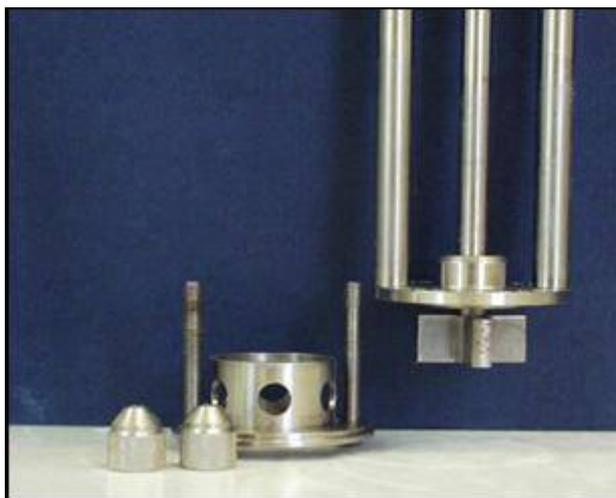
**Figura 16 – Hélice de Quatro Pás do Agitador utilizado para Geração de CGAs**
