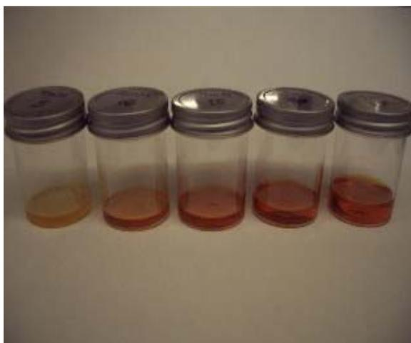
**Figura 62 – Fase Líquida após Recuperação de Norbixina com CGAs geradas por uma Solução 4 mmol/L de CTAB. Da esquerda para a direita cada frasco representa o volume de CGAs utilizado: 5, 10, 15, 20 e 30 mL**
