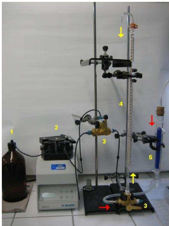
Figura III.7 - Imagem da unidade de bancada de adsorção em leito fixo. 1) Frasco de solução, 2) bomba peristáltica, 3) válvulas, 4) coluna de leito fixo, 5) coluna de secagem de gás.
