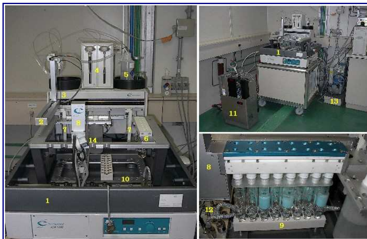
Figura III.4 - Componentes do CHEMSPEED. 1) suporte principal, 2) robô, 3) agulha, 4) seringas de 10 e 1 mL, 5) reservatório de solvente, 6) suporte de soluções estoques, 7) rinsagem de agulha, 8) suporte de reatores, 9) conjunto de 16 reatores, 10) agitador, 11) unidade de resfriamento e aquecimento, 12) linha de fluido transferência de calor, 13) unidade de vácuo, e 14) linha de vácuo.
