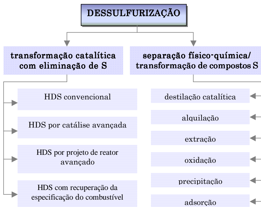
Figura II.4 - Tecnologias de dessulfurização classificadas pela natureza do processo chave para remover enxofre. Babich e Moulijn (2003).
