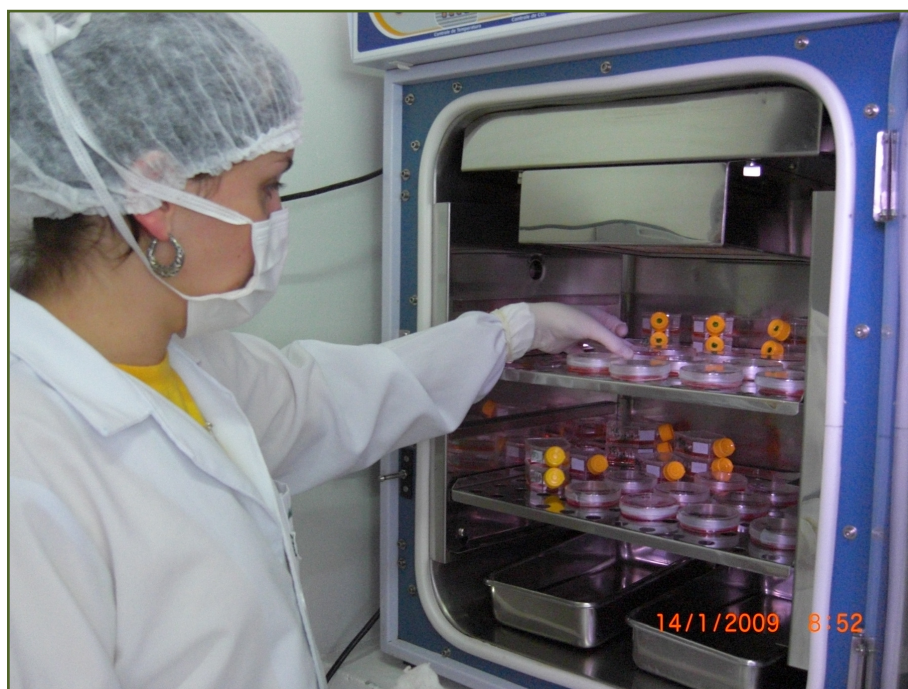
Figura 12: Armazenagem dos cultivos celulares em garrafas de polietileno, sob temperatura controlada em estufa com atmosfera de CO 2
