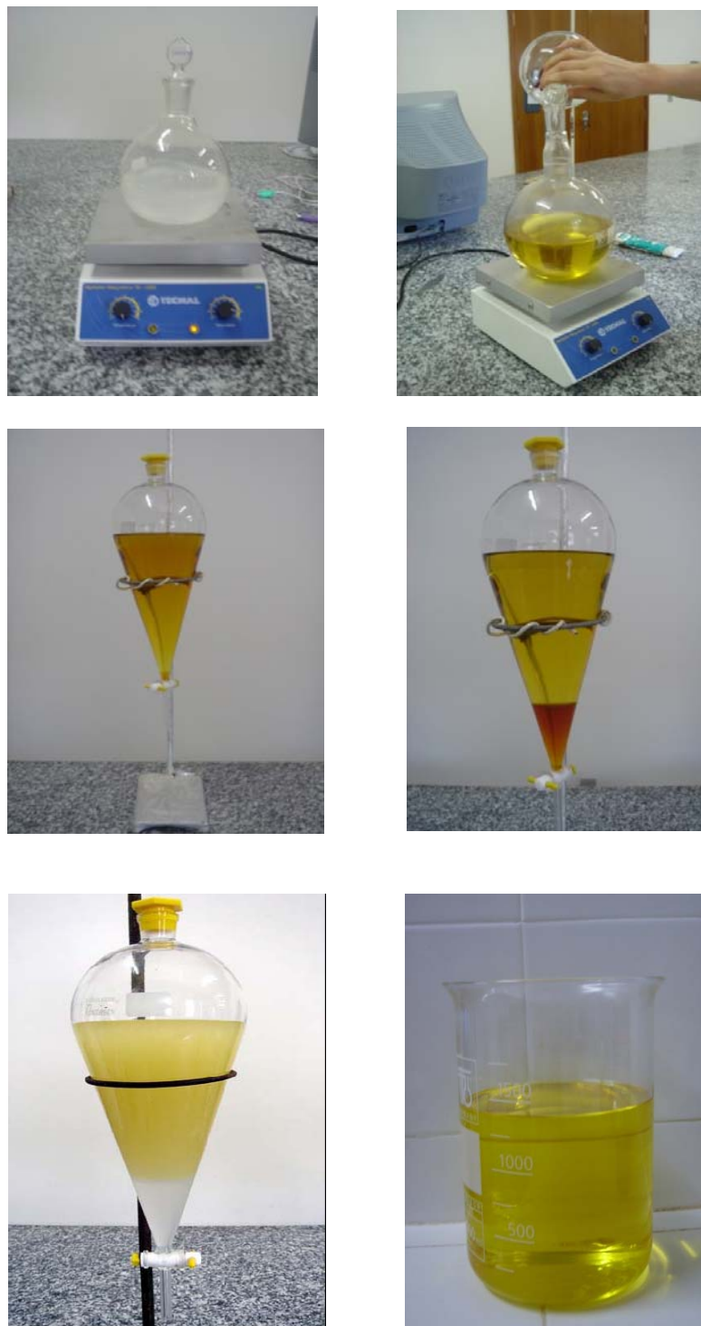
Figura 4.1 Processo de obtenção do biodiesel etílico de girassol: solução etanólica de potássio (a) , adição solução etanólica de potássio no óleo de girassol (b) , misturas para decantação (c) , separação das fases (d) , processo de lavagem (e) biodiesel etílico de girassol (f)
