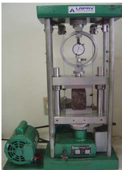
Figura 3.16 – Prensa para o ensaio de resistência à tração na compressão diametral.
