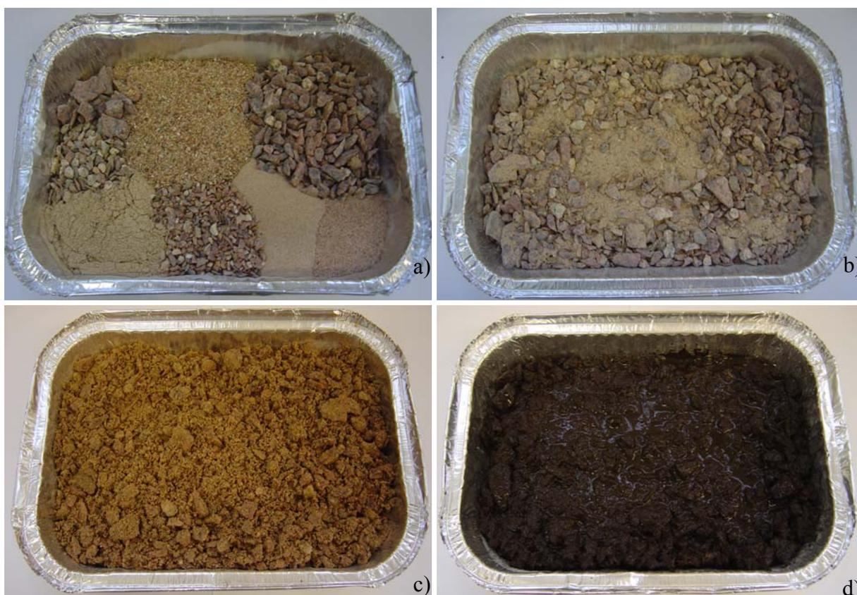
Figura 3.11 – Preparação da mistura: a) composição granulométrica; b) mistura a branco; c) mistura com água; d) mistura com emulsão.
