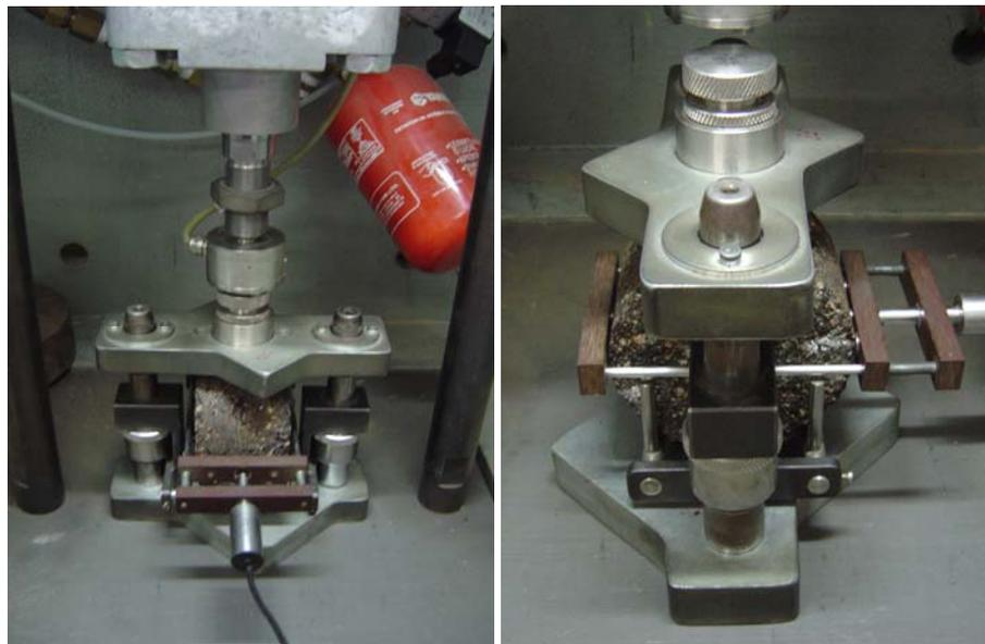
Figura 3.17 – Equipamento para o ensaio de módulo de resiliência.
