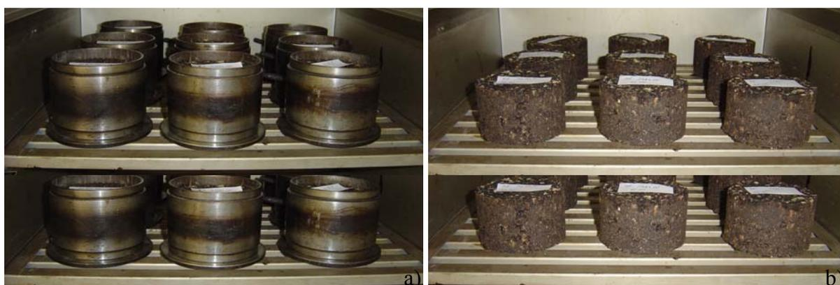
Figura 3.13 – Processo de cura pós-compactação dos corpos-de-prova: a) 24 horas iniciais e b) 24 horas finais.
