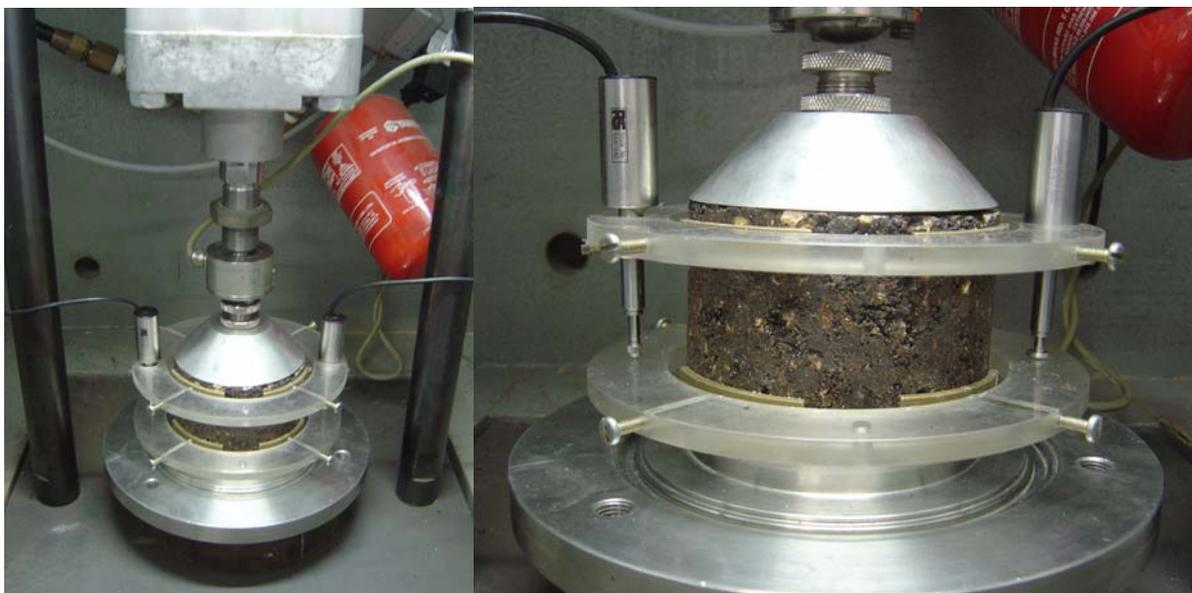
Figura 3.18 – Equipamento para o ensaio de *creep* dinâmico
