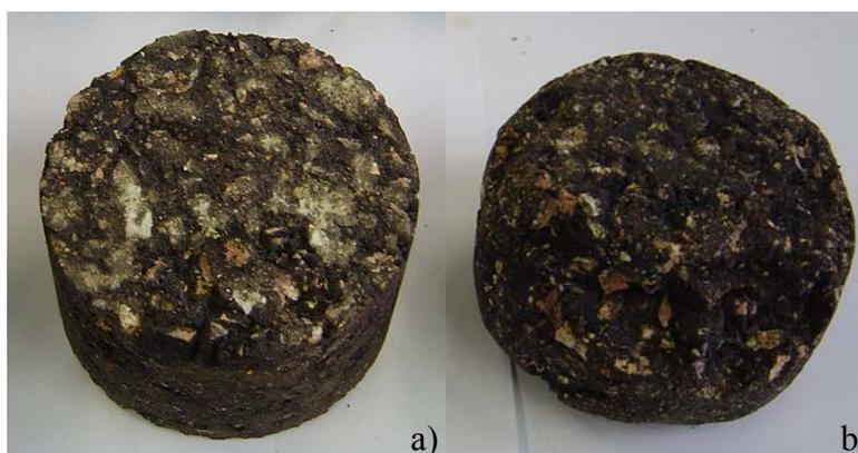
Figura 4.21 – Comparação do desgaste de uma mistura de *grave-émulsion*: a) antes e b) depois da execução do ensaio
