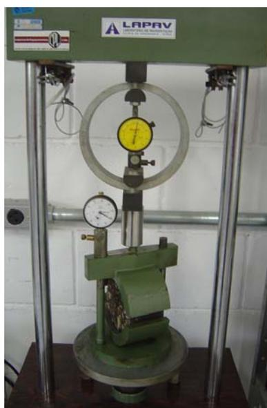
Figura 3.15 – Ensaio de estabilidade e fluência Marshall
