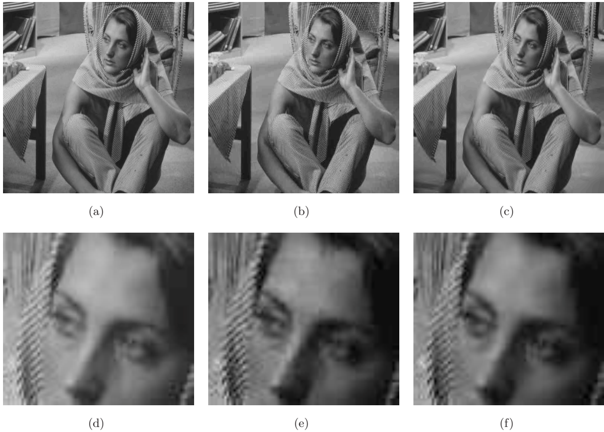
Figura 2.22: Comparação dos codificadores JPEG e JPEG2000: (a) imagem original (8 bits/pixel ); (b) imagem reconstruída com JPEG (PSNR = 28,3434 dB a 0,5076 bits/pixel ); e (c) imagem reconstruída com JPEG2000 (PSNR = 32,7589 dB a 0,4997 bits/pixel ). As imagens (d), (e) e (f) são ampliações das imagens (a), (b) e (c), respectivamente.
