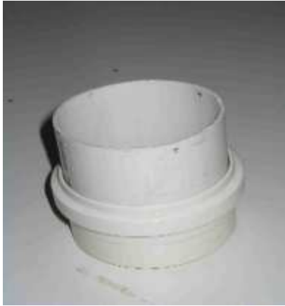
Figura 27: Coletor de água cinza em caixa sifonada para a coleta das amostras.
