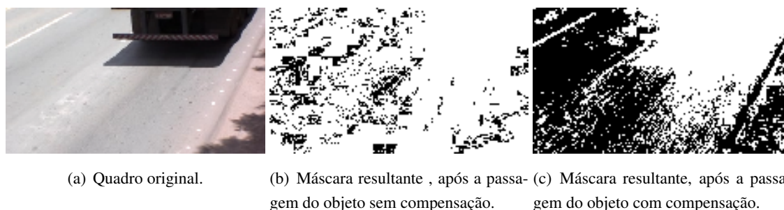
Figura 4.10: Compensação de mudanças de iluminação após a passagem do móvel.
