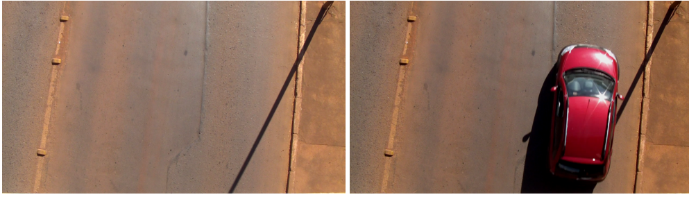
Figura 3.4: Exemplo de ofuscamento: (a) Imagem de fundo (b) Diminuição do ganho devido ao ofuscamento.
