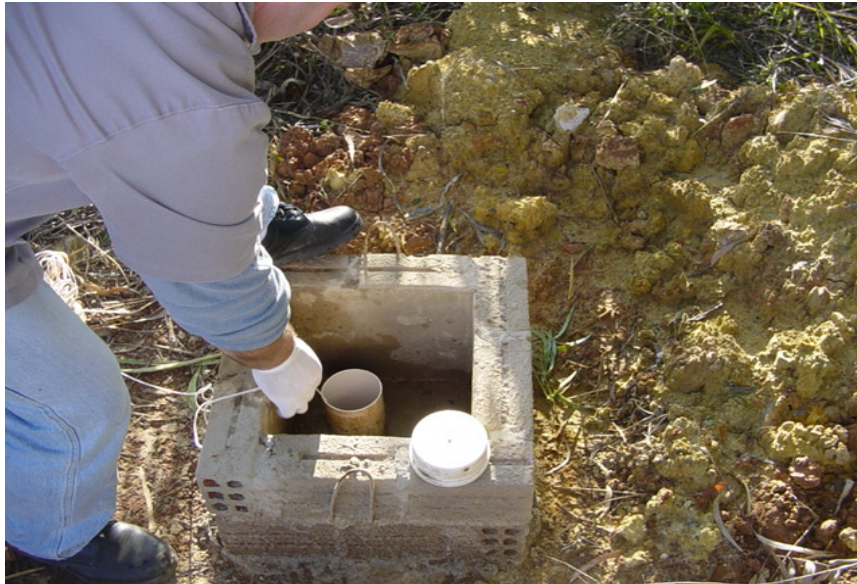
Figura 3.14 - Coleta de água subterrânea nos poços de monitoramento
