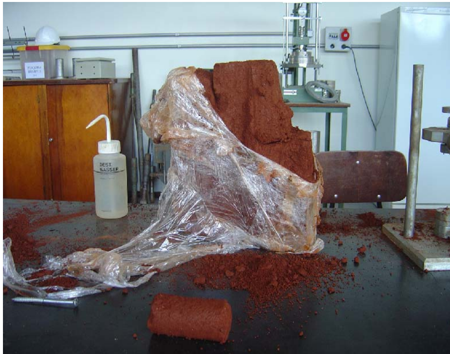
Figura 3.22 - Amostra de solo indeformada da área de aterro
