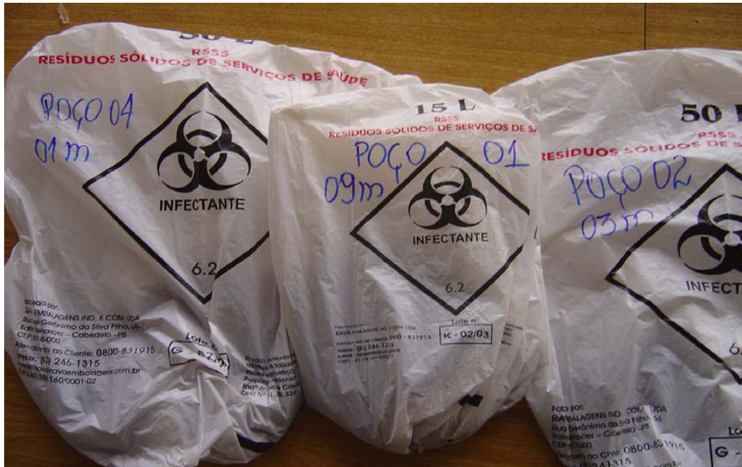
Figura 3.16 – Amostra de solo deformada – identificação e acondicionamento
