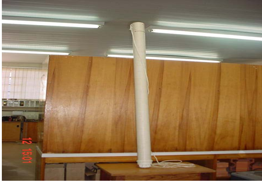
Figura 3.6 - Amostrador para retirada de água subterrânea dos poços de monitoramento
