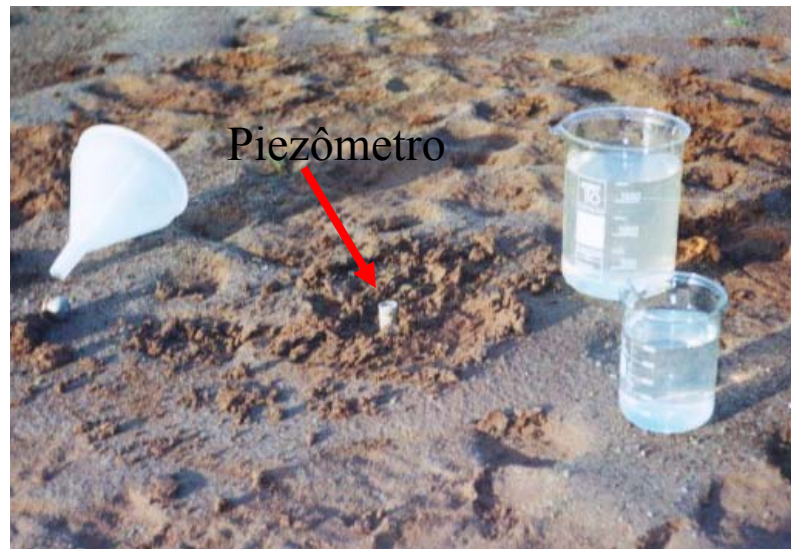
Figura 3.35 – Foto do ensaio de infiltração em piezômetro.
