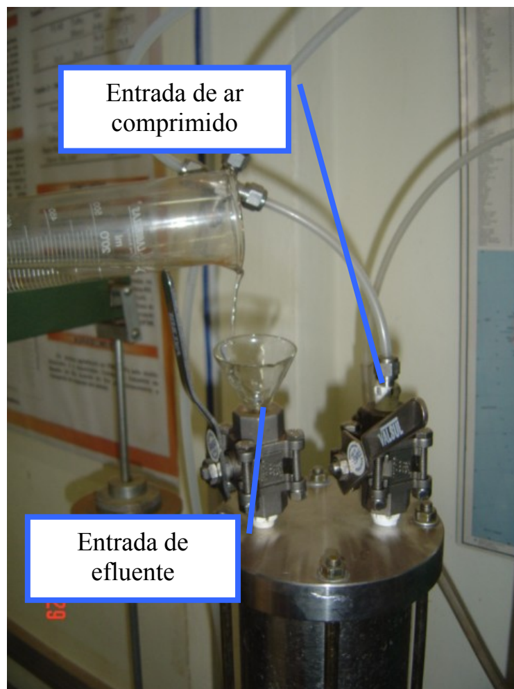
Figura 4.12 – Entrada de efluente e ar comprimido do Equipamento de Coluna.
