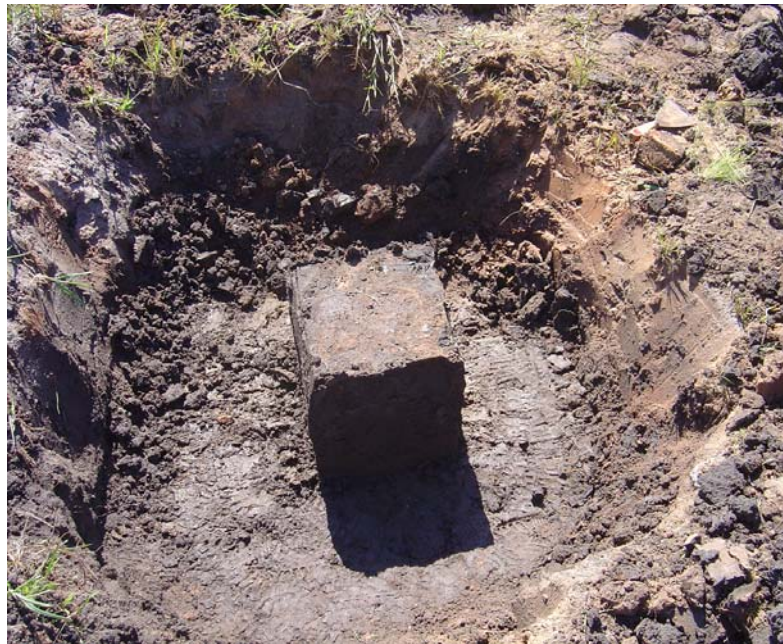
Figura 3.19 –Trincheira para a coleta das amostras indeformadas para o equipamento de coluna da área de corte
