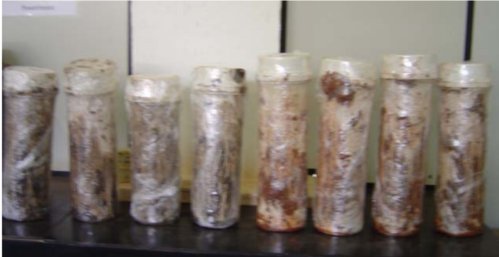
Figura 3.26 – Amostras indeformadas para o equipamento de colmatação no laboratório.
