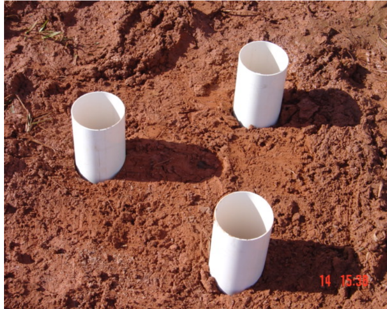
Figura 3.24 – Cravação dos tubos no solo para coleta das amostras indeformadas para o equipamento de colmatação.
