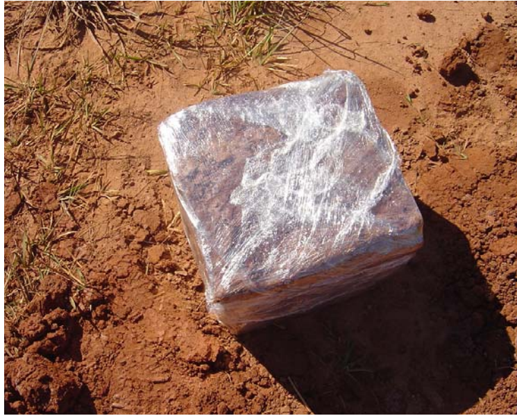
Figura 3.20 –Proteção dos blocos de solo utilizados na confecção dos corpos de prova para o equipamento de coluna.
