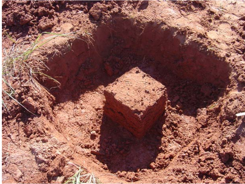
Figura 3.18 –Trincheira para a coleta das amostras indeformadas para o equipamento de coluna da área de aterro
