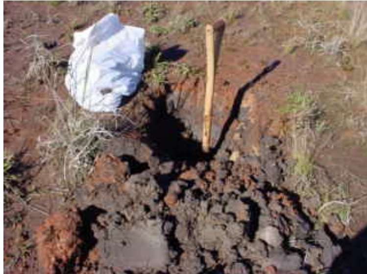
Figura 3.14 – Vala para coleta do solo da área de corte.
