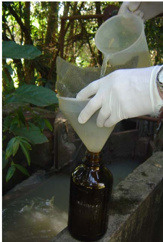
Figura 3.29 – Coleta do esgoto para o equipamento de coluna.
