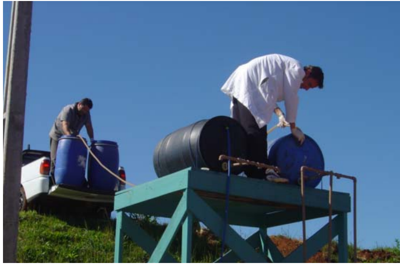
Figura 4.18 – Abastecimento do equipamento de colmatação com efluente.
