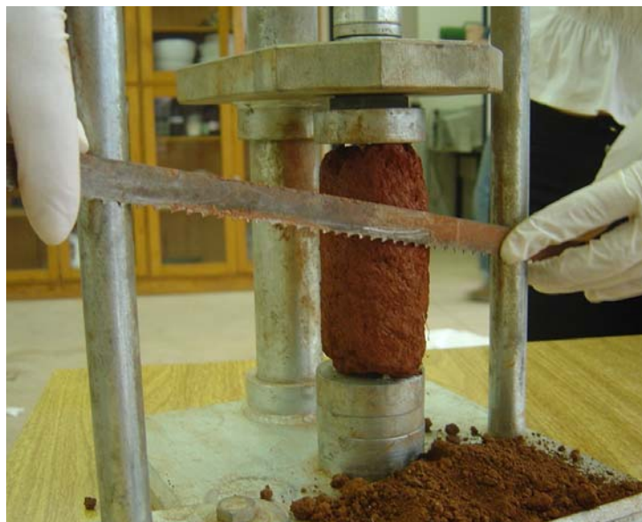
Figura 3.21 – Moldagem da amostra indeformada do solo da área de aterro para uso no equipamento de coluna.
