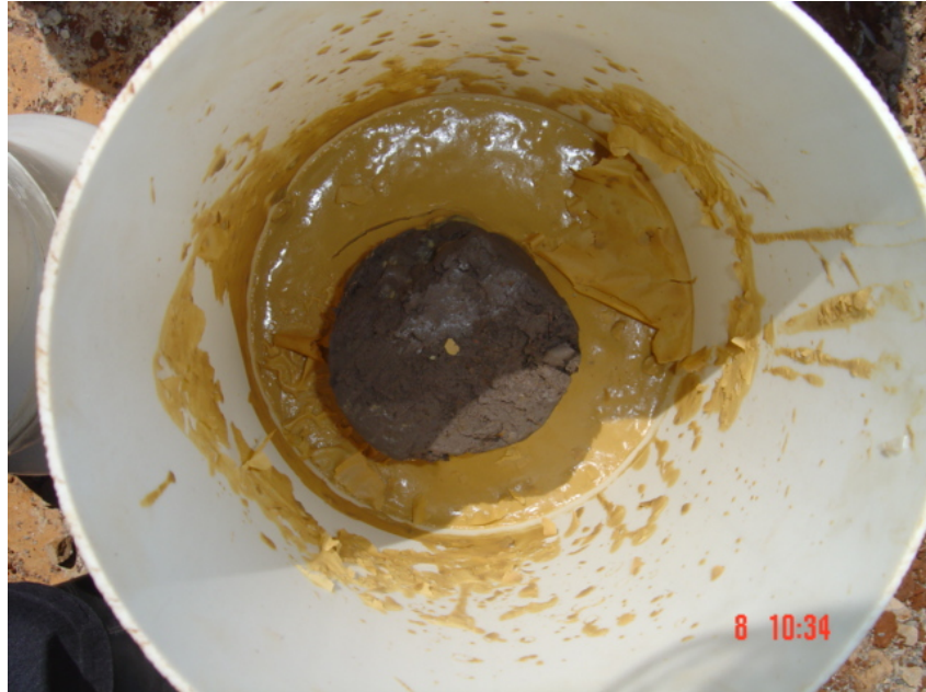
Figura 4.16 – Amostra de solo da área de corte com lama bentonita.
