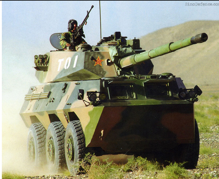
O mesmo carro, com torre e canhão 100 mm, o PTL02; considerado canhão de assalto, de uso antitanque.
