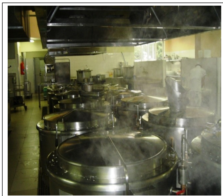
Figura 12: Vapor liberado pelos equipamentos na preparação das refeições
