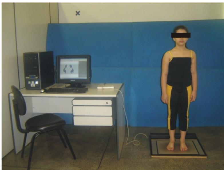
**Figura 2** - Sistema de baropodometria computadorizada mostrando uma coleta na posição BA.
