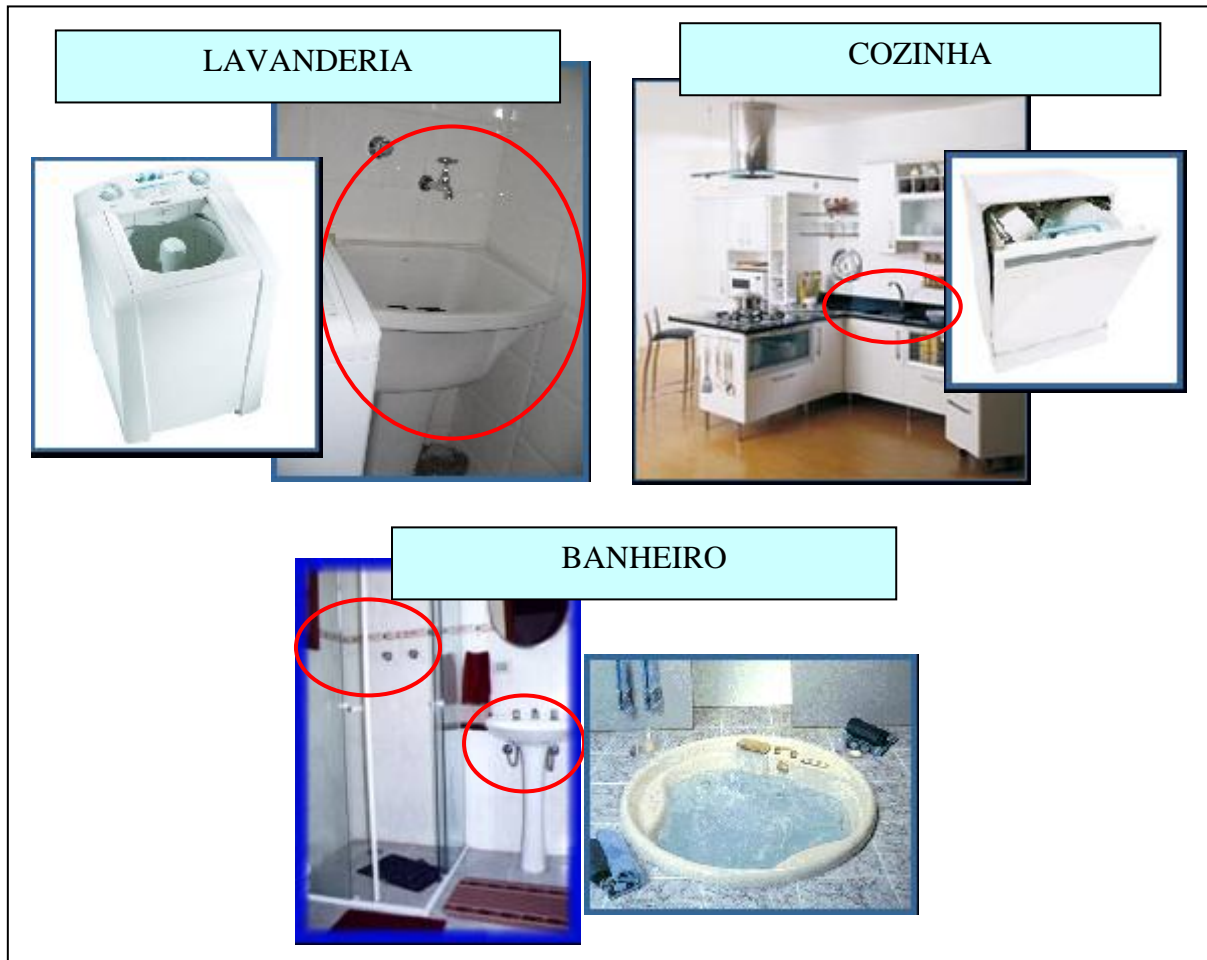
Figura 35: Pontos de água cinza gerados pelos aparelhos, em cada ambiente.
