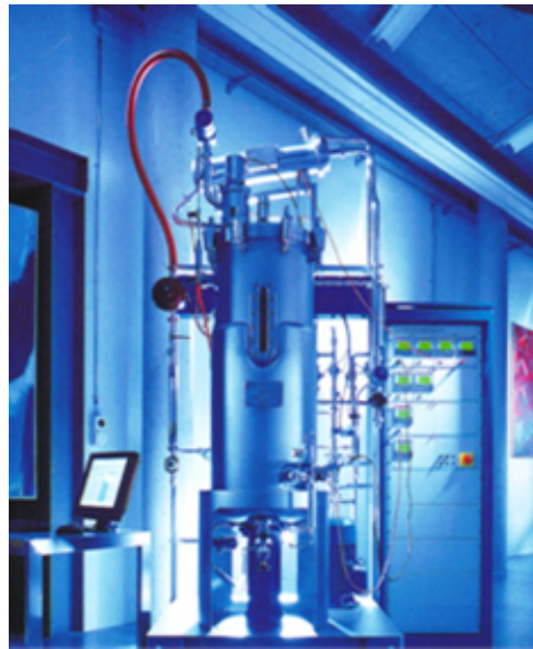
Figura 3.5 Biorreator de tanque agitado piloto, equipado com sistemas de controle para as diversas variáveis de processo (Fonte: Bioengineering AG).
