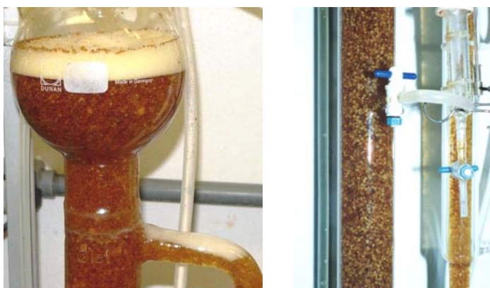
Figura 5.42 Crescimento na forma de pellets densos em biorreator airlift .
