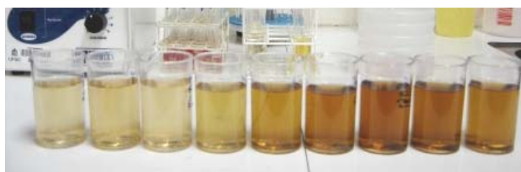
Figura 5.51 Variação na coloração do extrato de cultivo do fungo Rhizopogon nigrescens (UFSC-Rh90) em biorreator airlift a 25 \pm 1 °C a 0,52 vvm em função do tempo de cultivo.
