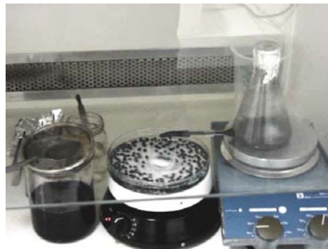
Figura 5.53 Dispositivo de encapsulamento da biomassa em gel de alginato de cálcio. A distribuição uniforme da biomassa foi garantida através da agitação constante.
