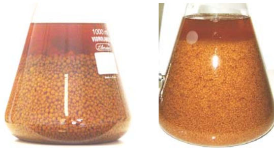
Figura 5.34 Biomassa de dois diferentes cultivos do isolado UFSC-Rh90 no biorreator airlift em inox, mostrando a diferença entre o tamanho dos pellets , resultantes de inóculos preparados com diferentes tempos de fragmentação.
