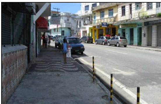
Figura 51 - Salvador: Bairro da Liberdade. Largura da calçada, lado esquerdo, 2,30 e 2,95 metros
