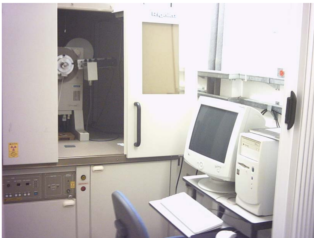
Figura 18 – Fotografia do difratômetro de raios X usado na realização das medidas.
