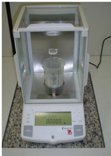
Figura 16 – Balança analítica usada para determinar a densidade das amostras.
