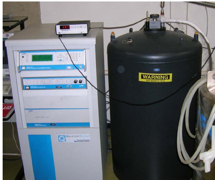
Figura 20 – Fotografia do Physical Property Magnetic System (PPMS); equipamento utilizado nas medidas de resistividade elétrica.
