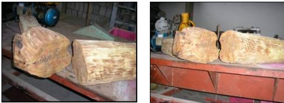
Figura A1 – Toras descascadas podendo-se observar o quantitativo de alburno ou branco e cerne ou durâmen da madeira.
