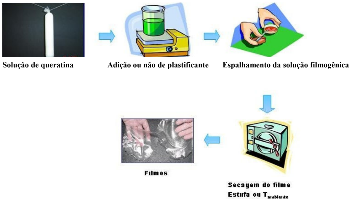
FIGURA 11 – Esquema representativo do processo usado para a obtenção de filmes de queratina de penas de aves.
