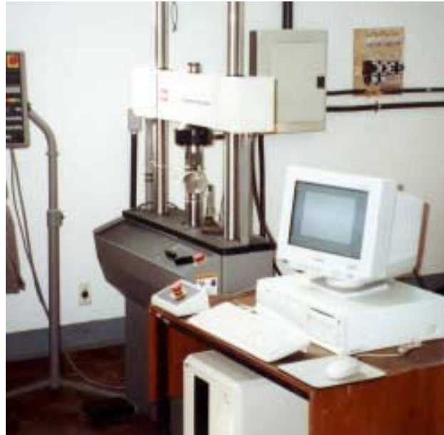
Figura 5.6 - Vista geral da máquina servohidráulica, MTS 10t, para ensaios de tenacidade à fratura e fadiga
