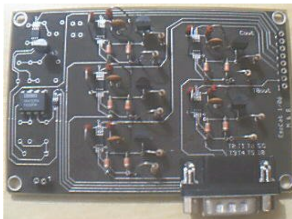
Figura 4.3: Placa de acondicionamento e amplificação de sinais.
