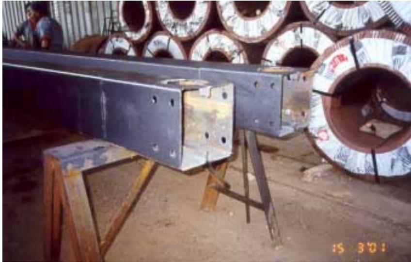
Figura 3.13 – Detalhe das vigas utilizadas observando-se o sistema de furação utilizado.
