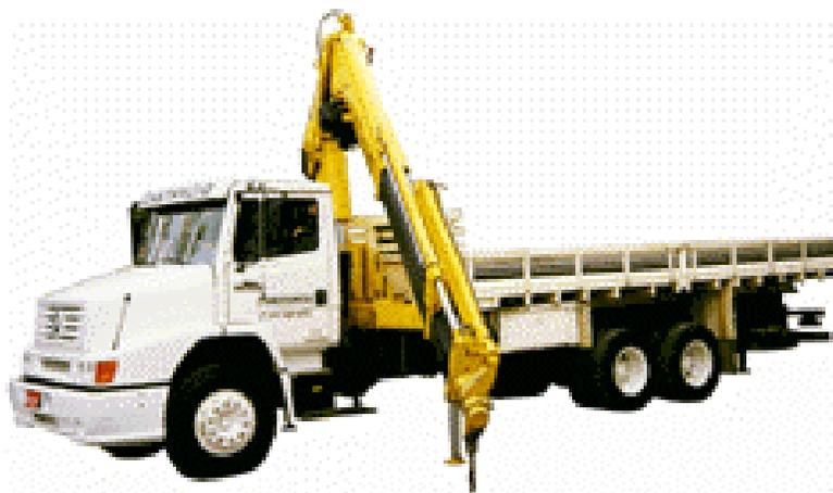
Figura 5.1 – Munck, caminhão dotado de guindaste hidráulico.
