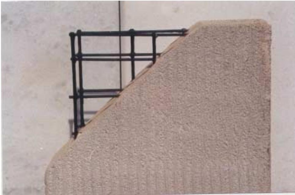
Figura 2.13 – Vista da armação dos painéis de concreto celular autoclavado
