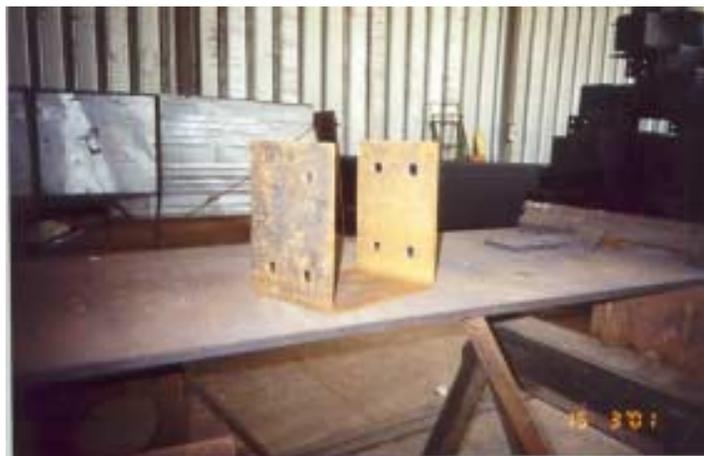
Figura 3.9 – Detalhe da luva utilizada para as ligações entre colunas e vigas.
