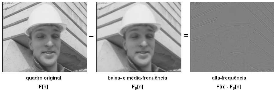
Figura 3.10: Exemplo de quadro chave redimensionado para simular a perda das altas-frequências onde se vê (a) quadro original, (b) quadro decimado e (c) quadro interpolado nitidamente borrado.
