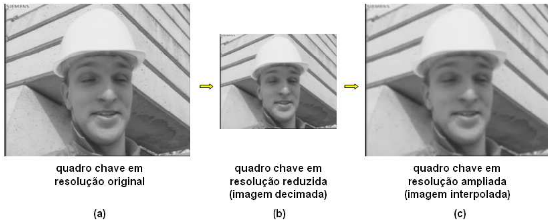
Figura 3.10: Exemplo de quadro chave redimensionado para simular a perda das altas-frequências onde se vê (a) quadro original, (b) quadro decimado e (c) quadro interpolado nitidamente borrado.
