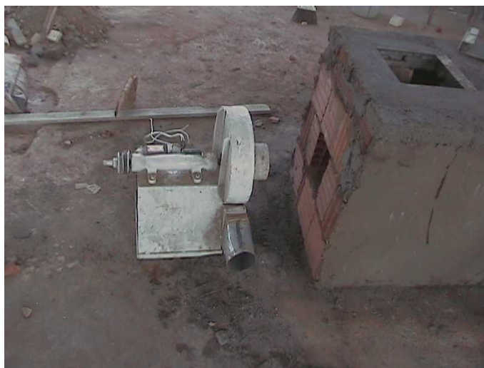
Figura 3.5: Acoplamento do ventilador ao misturador.
