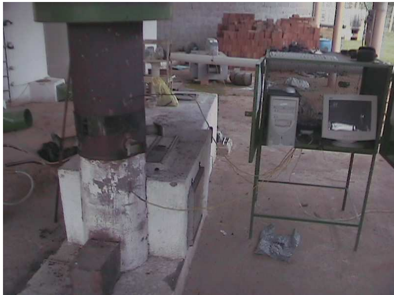
Figura 3.19: Gaseificador e sistema de aquisição de temperatura.
