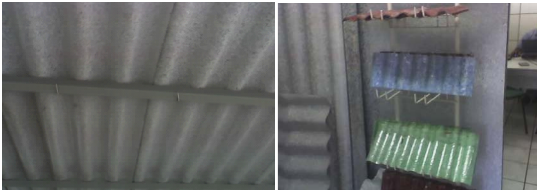
Figura 11 –Telhas fabricadas com resíduo plástico, com carga de alumínio.
