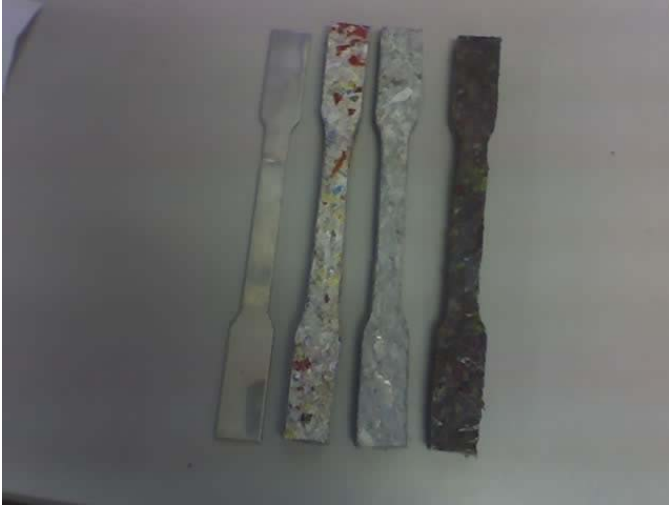
Figura 9- Material para teste de tração.
