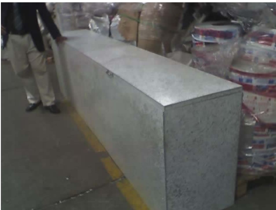
Figura 13- Caixa para armazenar resíduo de lâmpada fluorescente.
