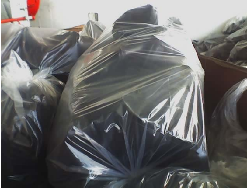
Figura 03 -Material SBR, rejeitado por falha no processo antes de ser moído
