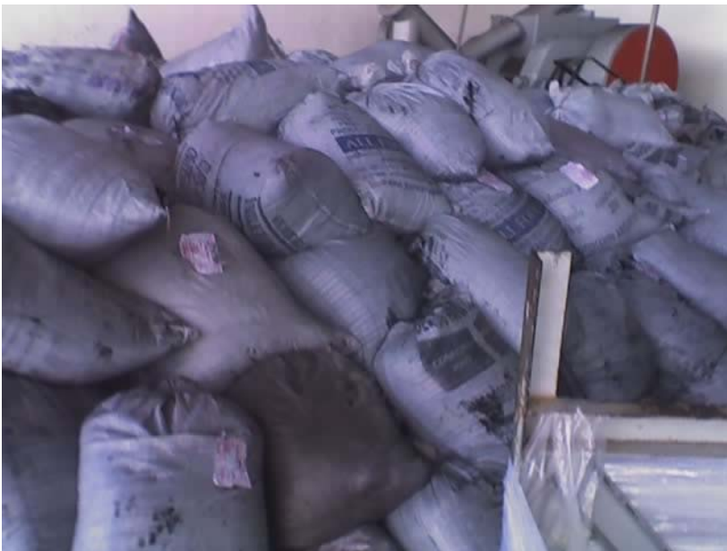
Figura 04- Material de SBR moído, para ser usado como combustível.
