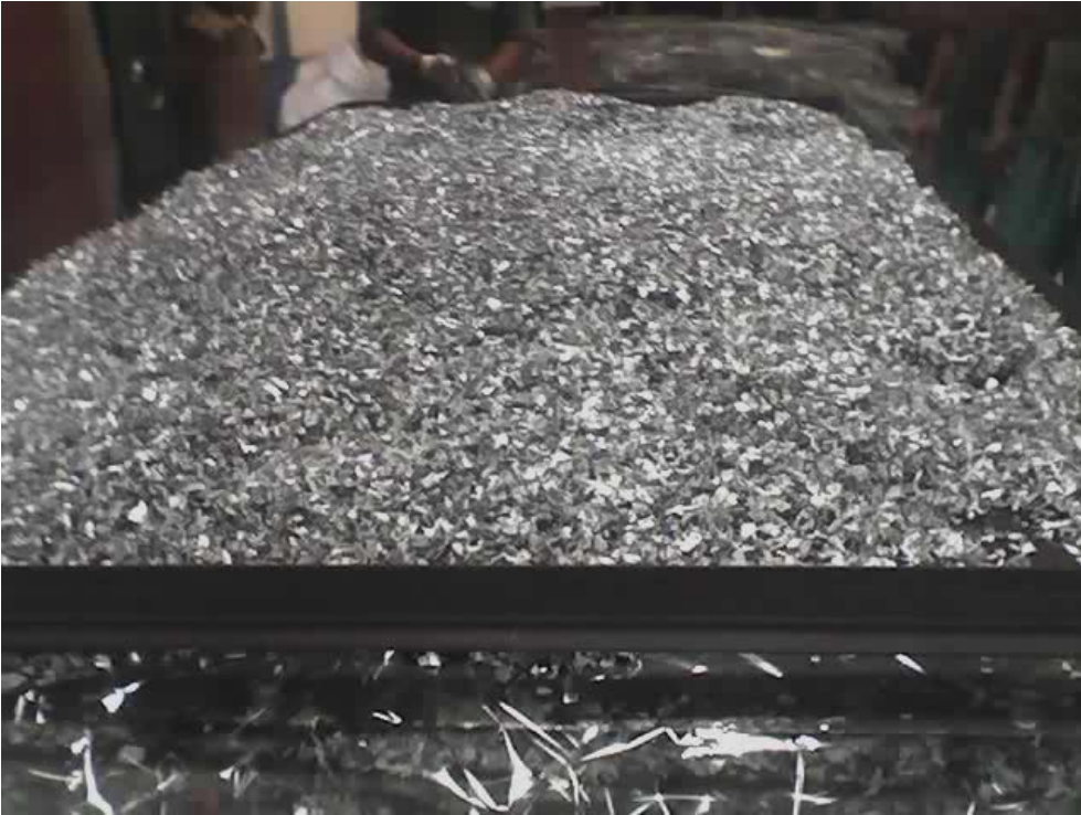
Figura 05 – Material moído e misturado para confecção das placas.
