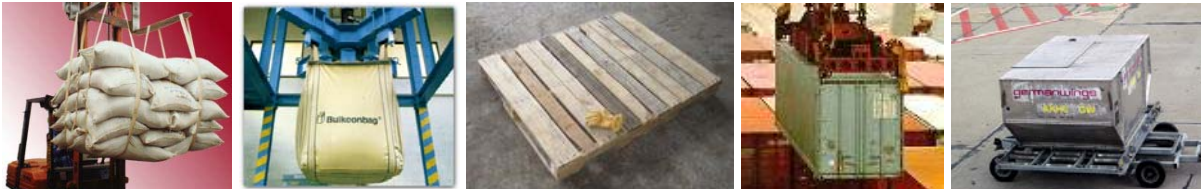
Figura 2. Dispositivos de unitização de carga. (na seqüência: sling , big-bag , palete, contêiner e ULD)
