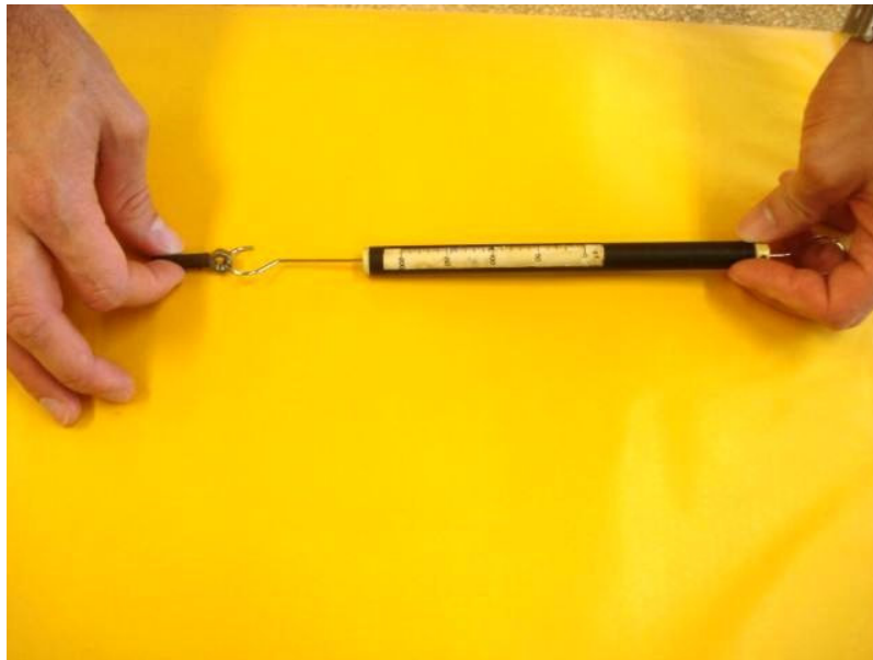
Figura 4 – Verificando a força de atração dos pólos de um ímã
