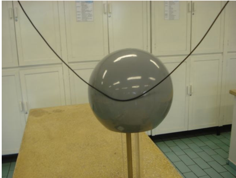
Figura 7 – Gerador eletrostático atraindo um fio condutor
