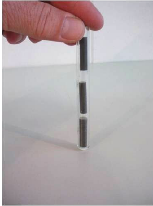
Figura 3 – Ímãs se repelindo (pólo iguais)
